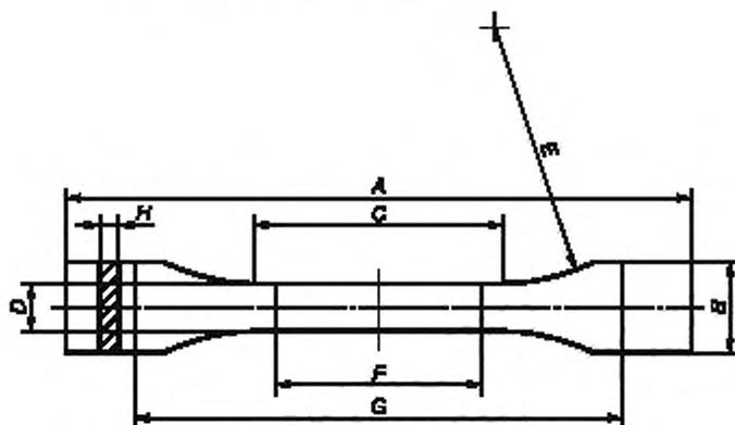
Рисунок 1 — Испытуемый образец типа 1
