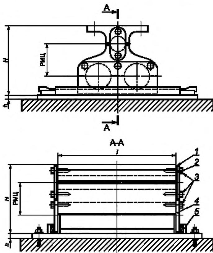
$H$  — высота опорной части;  $PMЦ$  — расстояние между осями шарнира и катков;  $h$  — толщина подопорного листа; 1 — прокладка; 2 — накладка, объединяющая верхний и нижний балансиры; 3 — болты M24 × 80; 4 — накладка, объединяющая нижний балансир с опорной плитой; 5 — замок
