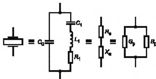
Рисунок 1 — Обозначения и эквивалентная электрическая схема пьезоэлектрического резонатора
