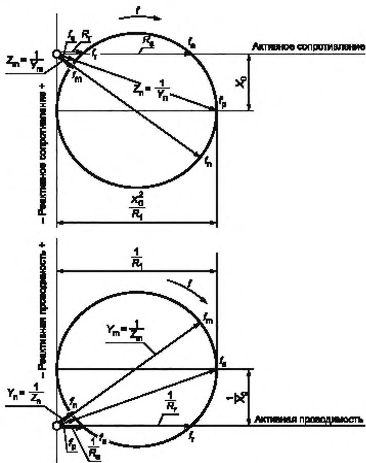
Рисунок 3 — Диаграмма импеданса и полной проводимости пьезоэлектрического резонатора
