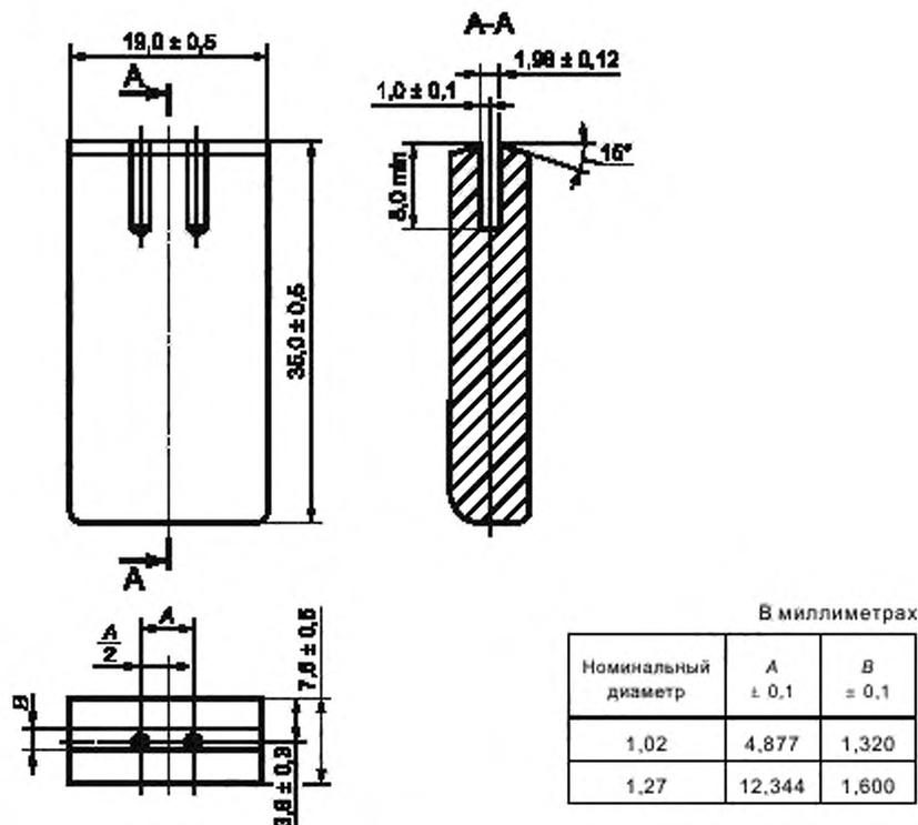
Рисунок 6 — Инструмент для испытания выводов на изгиб
