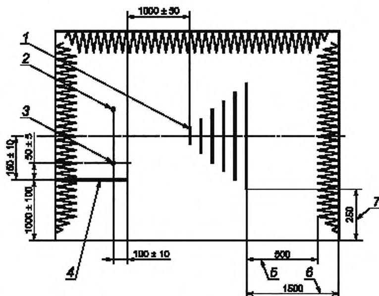
1 — антенна; 2 — плоскость, в которой находится контрольная точка и основная часть комплекта соединительных кабелей; 3 — контрольная точка; 4 — пластина заземления; 5 — минимальное расстояние элементов антенны от поглощающего радиоволны материала; 6 — минимальное расстояние элементов антенны от стены экранированного помещения; 7 — минимальное расстояние элементов антенны от пола экранированной камеры
