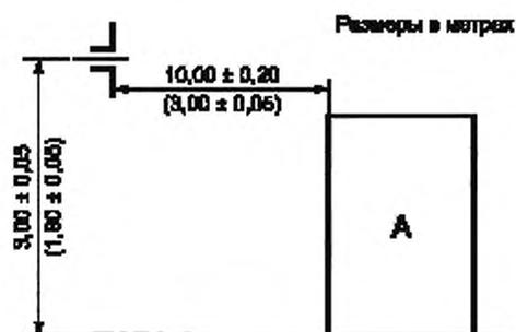
в) Положение симметричной дипольной антенны для измерения вертикальной компоненты излучения
