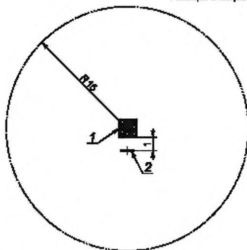
1 — испытуемый образец на пластине заземления; 2 — антенна
