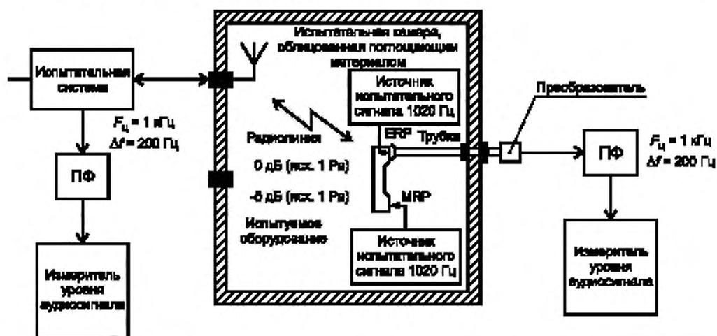
ПФ — полосовой фильтр;  $F_{ц}$  — центральная частота полосы пропускания фильтра;  $\Delta f$  — полоса пропускания фильтра, ERP — опорная точка уха; MRP — опорная точка рта
