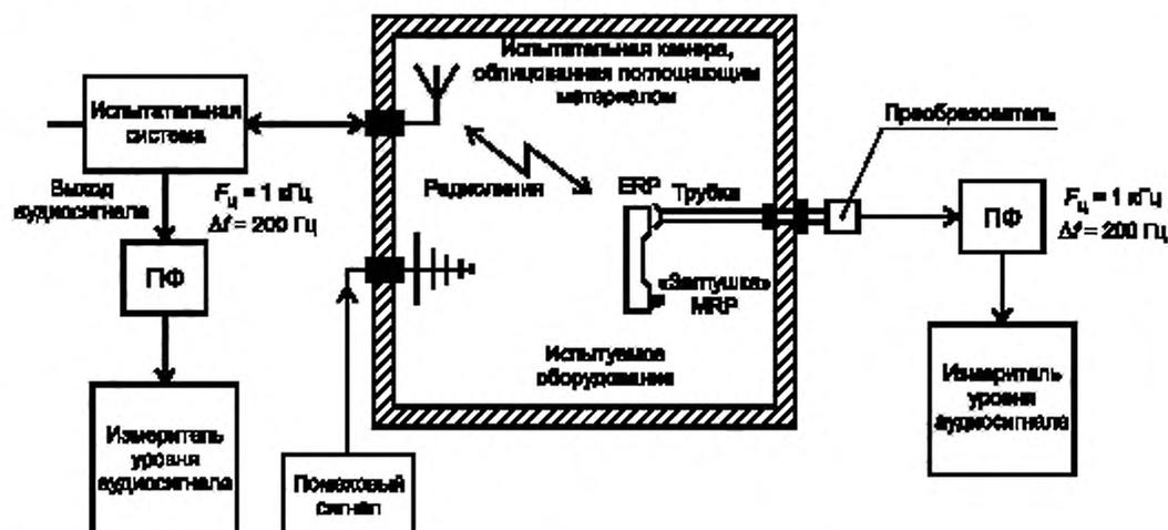
ПФ — полосовой фильтр;  $F_{ц}$  — центральная частота полосы пропускания фильтра;  $\Delta f$  — полоса пропускания фильтра; ERP — опорная точка уха; MRP — опорная точка рта
