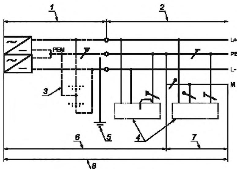
1 — источник питания; 2 — электроустановка; 3 — аккумуляторная батарея, которая не является обязательной; 4 — открытые проводящие части; 5 — заземление системы
