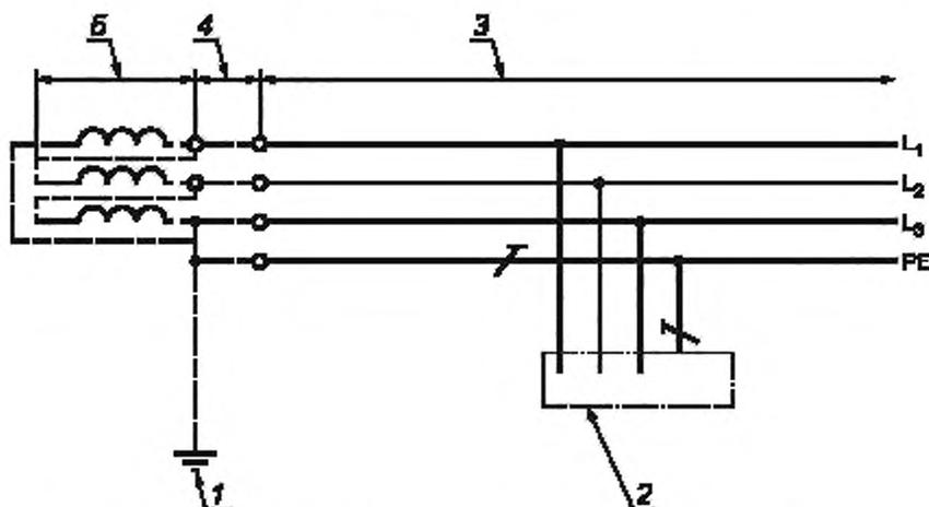
1 — заземление источника питания, 2 — открытые проводящие части; 3 — электроустановка; 4 — распределительная сеть (при ее наличии); 5 — источник питания
