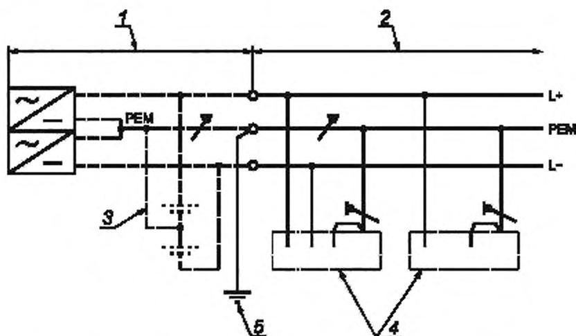
1 — источник питания, 2 — электроустановка; 3 — аккумуляторная батарея, которая не является обязательной; 4 — открытые проводящие части; 5 — заземление системы
