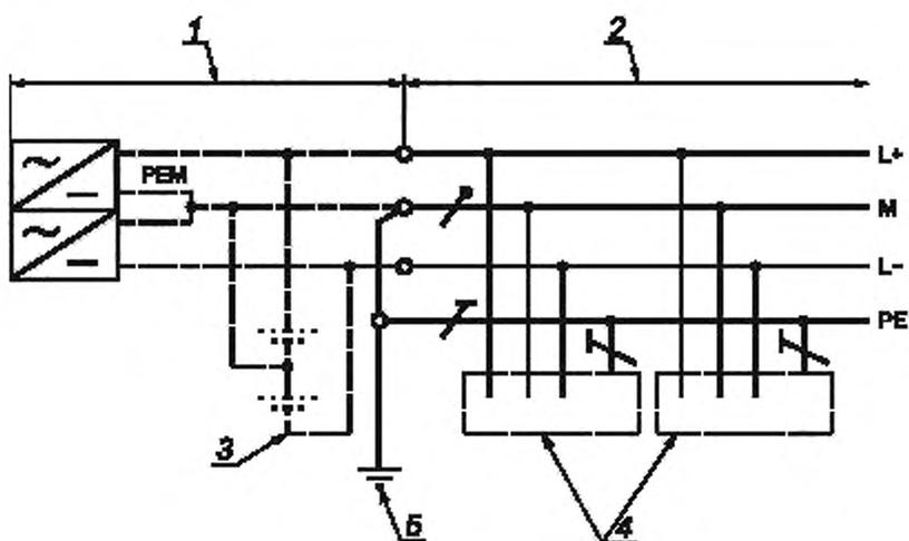
1 — источник питания; 2 — электроустановка; 3 — аккумуляторная батарея, которая не является обязательной, 4 — открытые проводящие части; 5 — заземление системы
