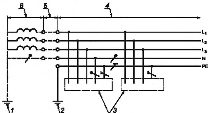
1 — заземление источника питания; 2 — защитное заземление в электроустановке; 3 — открытые проводящие части; 4 — электроустановка; 5 — распределительная сеть (при ее наличии); 6 — источник питания
