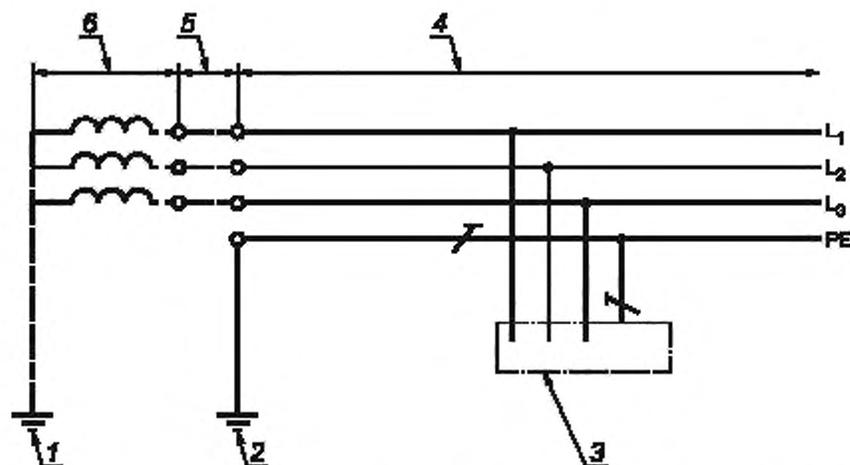
1 — заземление источника питания; 2 — защитное заземление в электроустановке; 3 — открытая проводящая часть; 4 — электроустановка; 5 — распределительная сеть (при ее наличии); 6 — источник питания
