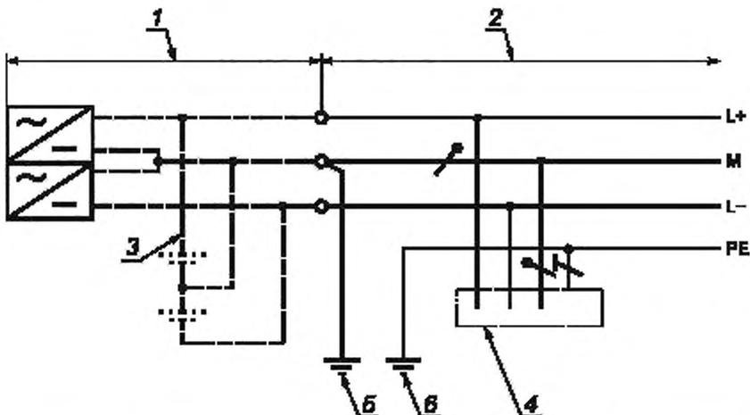
1 — источник питания; 2 — электроустановка; 3 — аккумуляторная батарея, которая не является обязательной, 4 — открытые проводящие части; 5 — заземление системы; 6 — заземление открытых проводящих частей
