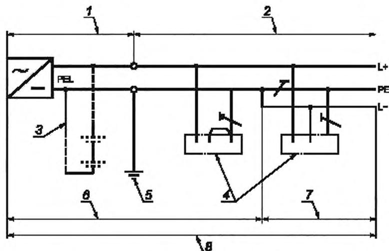
Примечание 1 — В электроустановке допускается дополнительное заземление защитного проводника (PE).
