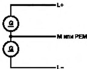
Рисунок 7 — Трехпроводная система
