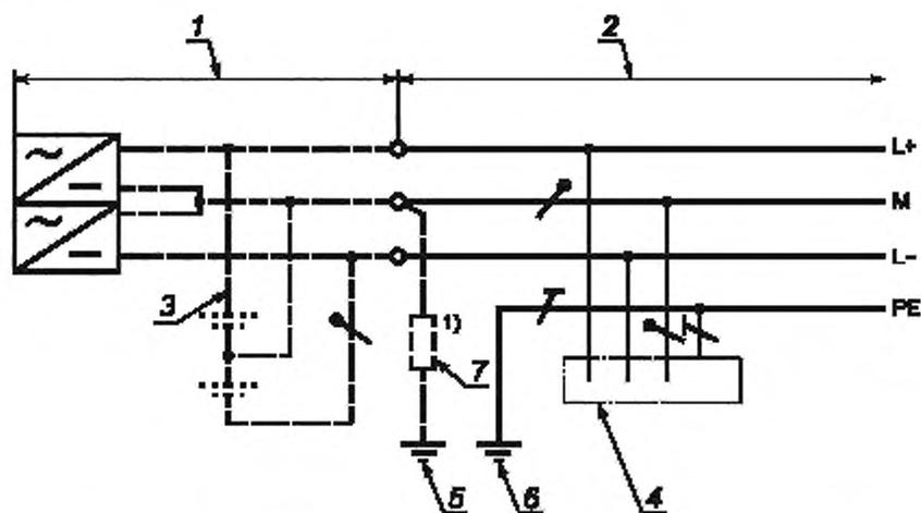
1 — источник питания; 2 — электроустановка; 3 — аккумуляторная батарея, которая не является обязательной; 4 — открытые проводящие части; 5 — заземление системы; 6 — заземление открытых проводящих частей; 7 — полное сопротивление
