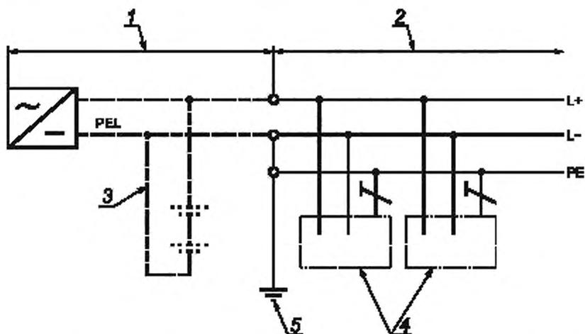
Примечание 1 — В электроустановке допускается дополнительное заземление защитного проводника (PE).
