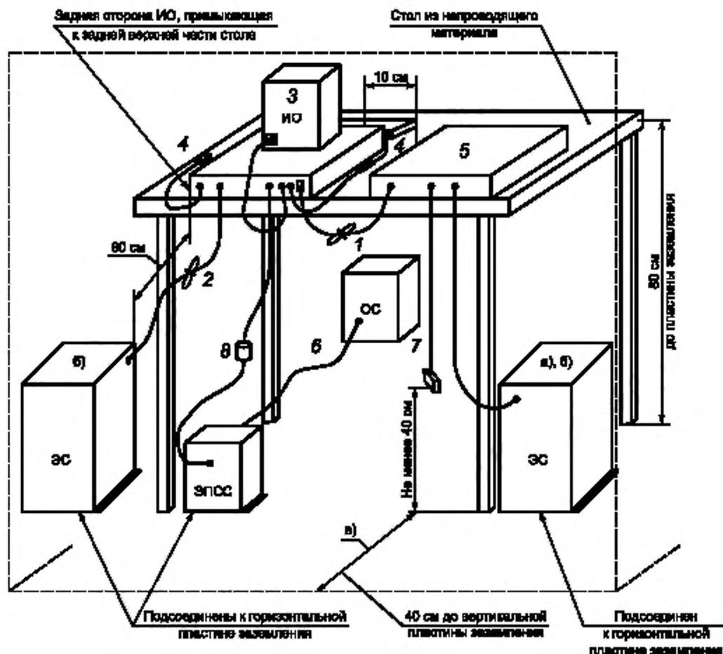
ЭС — V-образный эквивалент сети; ИО — испытуемое оборудование; ОС — оборудование, связанное с ИО; ЭПСС — эквивалент полного сопротивления сети.
