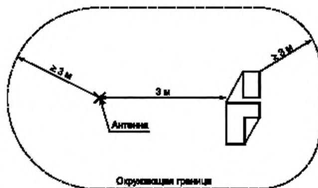
Примечание — Внутри объема, ограниченного на поверхности земли линией, указанной на рисунке, а по высоте — горизонтальной плоскостью, расположенной на высоте не менее 3 м над самым высоким элементом измерительной антенны или ИО, не должно быть отражающего объекта.
