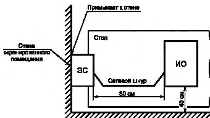
Рисунок 6 — Альтернативное (вид сверху) расположение настольного оборудования при испытаниях (измерение кондуктивных ПЭМИН)
