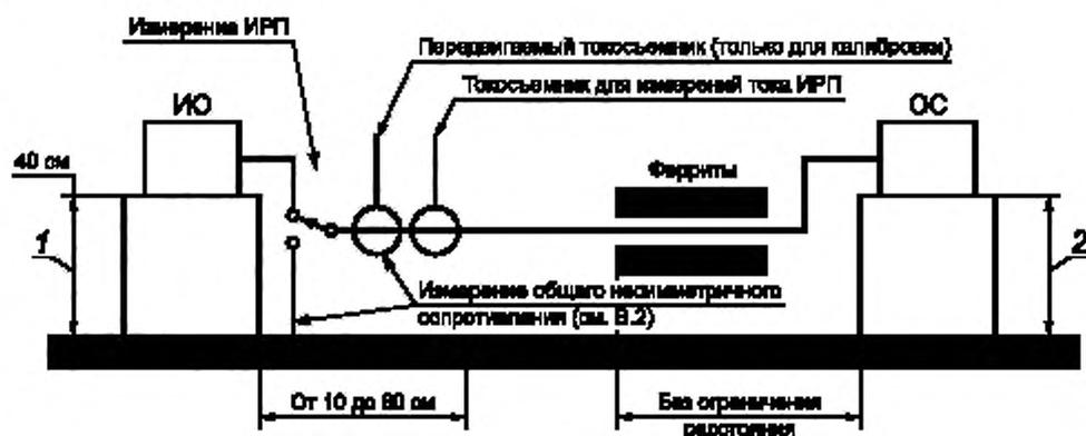
1 — расстояние до пластины заземления (вертикальной или горизонтальной). 2 — расстояние до пластины заземления (не является критическим)
