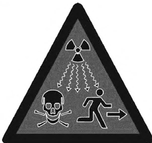
Рисунок 1 — Дополнительный знак, предупреждающий об ионизирующем излучении
