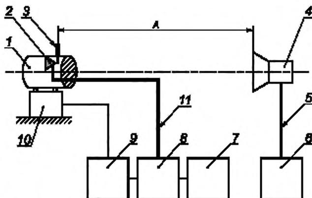
1 — фрагмент макета ВС; 2 — детекторная секция; 3 — измеряемая антенна; 4 — облучающая антенна; 5 — фидер питания; 6 — высокочастотный генератор; 7 — регистрирующее устройство (самолисец, ЛЭМВ+АЦП); 8 — усилитель; 9 — пульт управления; 10 — поворотное устройство; 11 — приемный тракт
