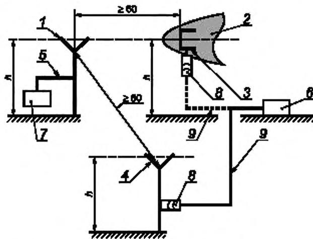
1 — облучающая антенна; 2 — фрагмент макета ВС; 3 — измеряемая антенна; 4 — эталонная (измерительная) антенна; 5 — фидер питания; 6 — измерительный приемник; 7 — генератор высокой частоты; 8 — соединитель тракта приема; 9 — высокочастотный кабель
