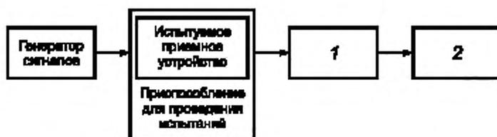
1 — устройство связи; 2 — прибор для оценки технической характеристики приемного устройства (например, коэффициента искажений, вероятности битовых ошибок (BER) и т.п.).
