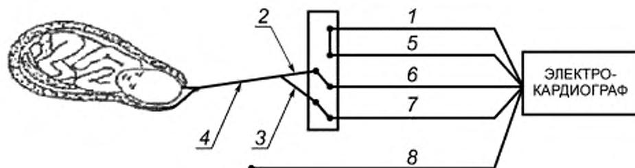
1 — зеленый провод электрода; 2 — красный провод электрода; 3 — желтый провод электрода; 4 — желтый провод отведения; 5 — белый провод отведения; 6 — красный провод отведения; 7 — желтый провод отведения; 8 — черный нейтральный провод
