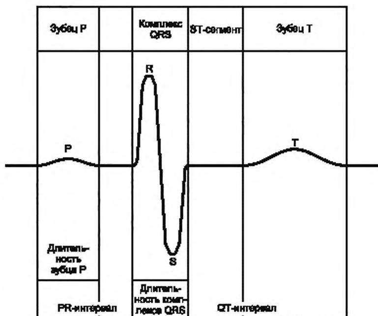
Рисунок II.3 — Перечень параметров калибровочных ЭКГ
