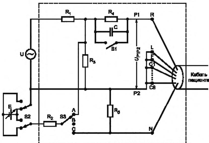
Генератор  $U$  должен иметь изолированный выход. При испытании ЭЛЕКТРОКАРДИОГРАФОВ с РАБОЧЕЙ ЧАСТЬЮ ТИПА VF или CF экранирующий кожух может заземляться.
