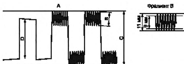
A — Синусоидальный сигнал частотой 40 Гц, B —  $10 \pm 0,5$  мм; C — Эффективная ширина регистрации;
