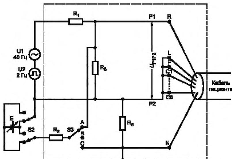
Генераторы U1 и U2 должны иметь изолированные выходы. При использовании РАБОЧЕЙ ЧАСТИ ТИПА ВF или CF экранирующий кожух может заземляться.
