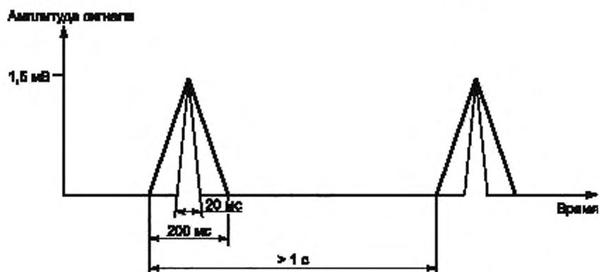
Рисунок 105 — Импульсы треугольной формы для испытания типа Е
