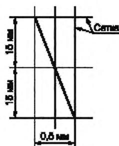
Рисунок 109 — Проверка прямоугольности системы координат (см. 51.108.4.1)
