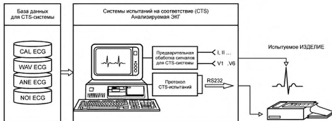
Рисунок И.1 — Система испытаний изделия на соответствие (CTS-система)
