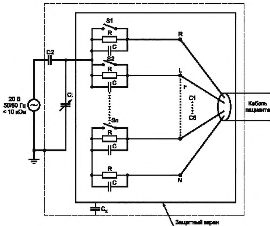
$R = 51 \text{ кОм}$ ;  $C = 47 \text{ нФ}$ ;  $C_2 = 100 \text{ пФ}$ ;  $C_2$  и  $C_t$  имитируют емкость пациента относительно земли. Для получения дополнительных сведений см. приложение FF.
