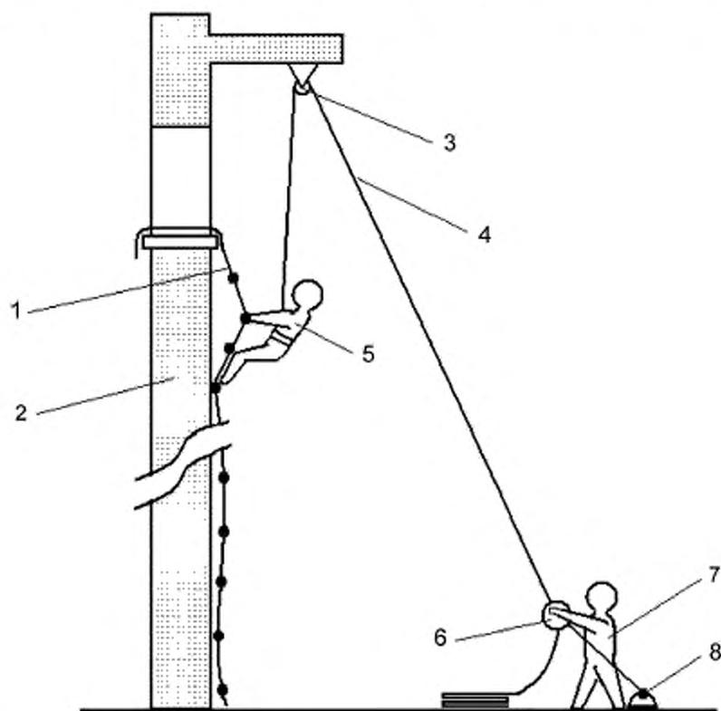
1 — лестница; 2 — здание; 3 — блок; 4 — страховочная веревка; 5 — испытатель; 6 — приспособление для экстренного торможения веревки; 7 — оператор, осуществляющий страховку испытателя, 8 — якорь
