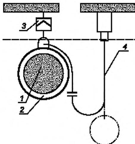
1 — груз; 2 — пояс; 3 — расцепляющее устройство; 4 — канат стальной
