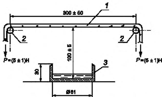
1 — образец ленты; 2 — опоры; 3 — емкость для горячего
