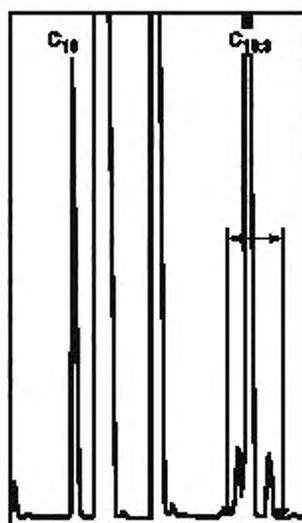
Сложные эфиры следующих кислот: C<sub>18</sub> — стеариновая кислота; C<sub>18:3</sub> — линоленовая кислота
