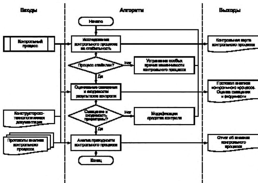
Рисунок 11 — Схема первоначального оценивания статистических характеристик контрольных процессов
