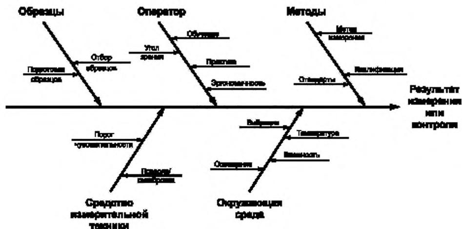
Рисунок 13 — Группы причин изменчивости измерительного или контрольного процесса
