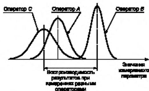
Рисунок 6 — Воспроизводимость результатов при измерениях разными операторами
