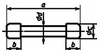
Материал — твердая сталь. Части, подверженные износу, должны быть упрочнены.
