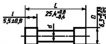
Максимальный диаметр патрона  $d$  должен быть менее диаметра колпачков  $D$ .
