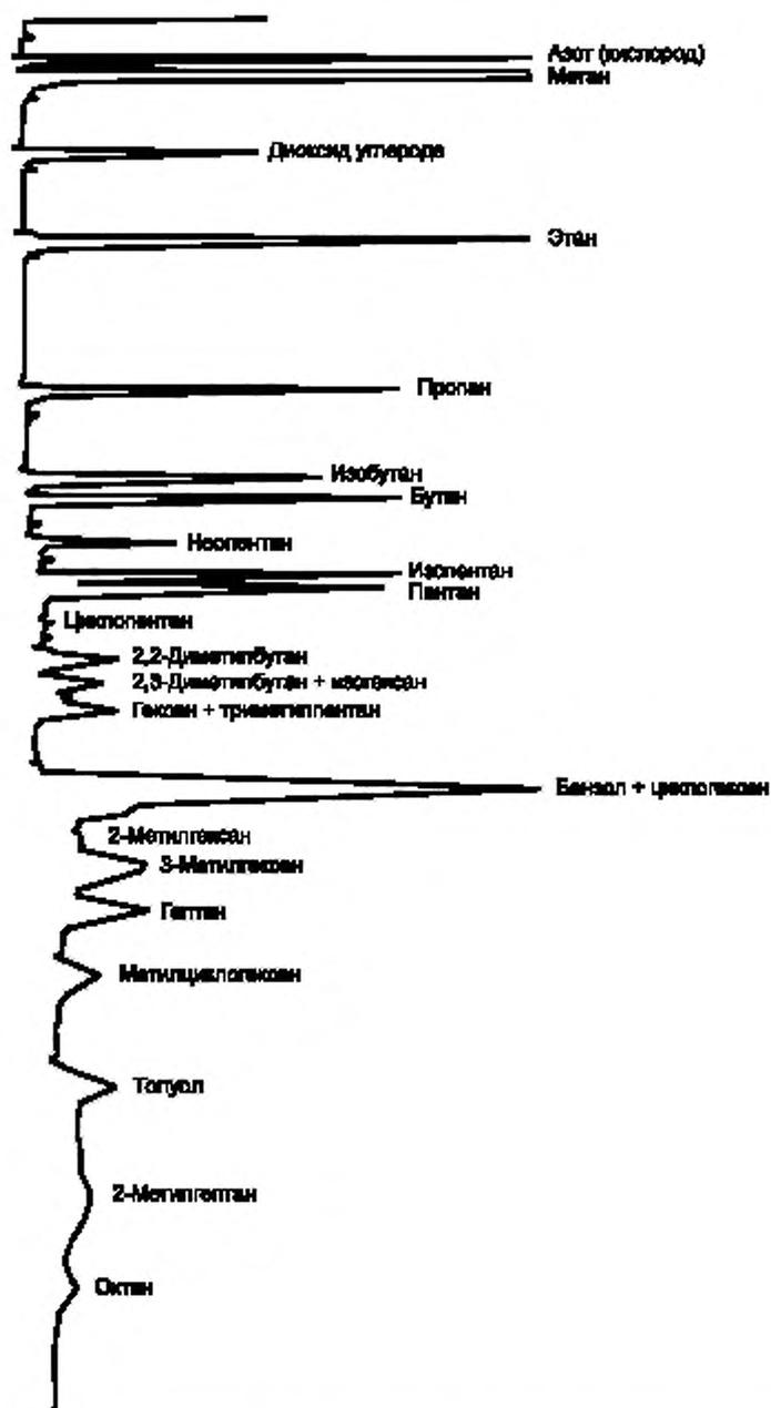
Рисунок А.2 — Типичная хроматограмма азота (кислорода), диоксида углерода и углеводородов от C<sub>1</sub> до C<sub>8</sub> на колонке с Porapak R
