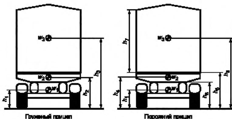
Рисунок X.1 — Расположение центров масс отдельных элементов прицепа
