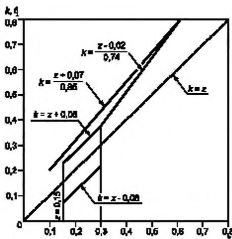
Рисунок К.3 — График использования сил сцепления для транспортных средств категорий иных, чем  $M_1$ ,  $N_1$  и полные прицепы
