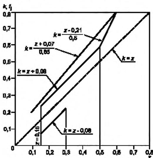
Рисунок К.2 — График использования сил сцепления для транспортных средств категории  $N_1$ , за исключением транспортных средств этой категории, упомянутых в К.3.1.2.2
