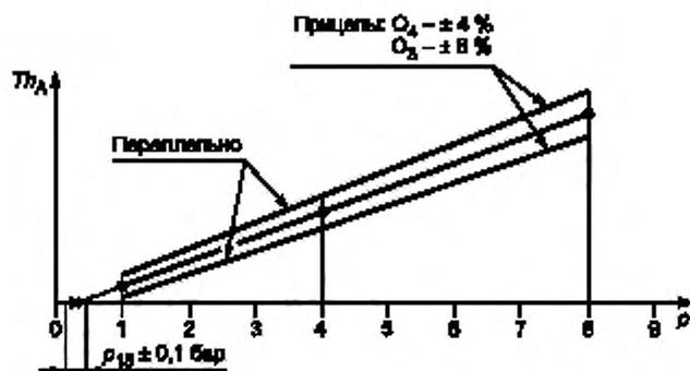
Рисунок Ф.1 — Зависимость толкающего усилия от давления в тормозной камере
