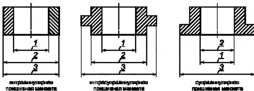
1 — проходное отверстие клапана, 2 — посадочный диаметр (размер) клапана, 3 — наружный диаметр клапана
