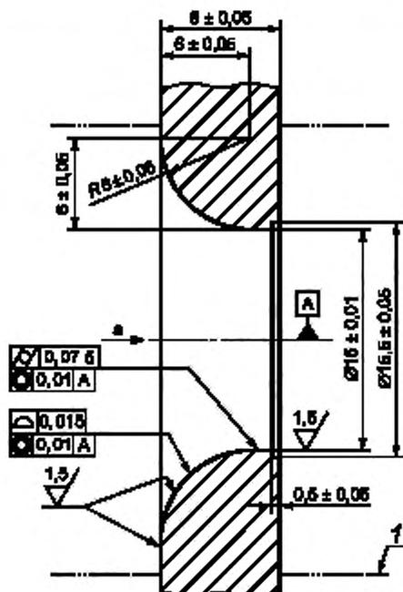
Рисунок 3 — Стандартное сопло для контроля испытаний в прямом потоке
