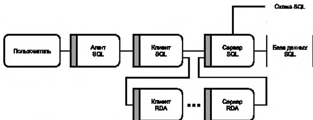
Рисунок В.5 — Модель управления распределенными данными применительно к RDA SQL
