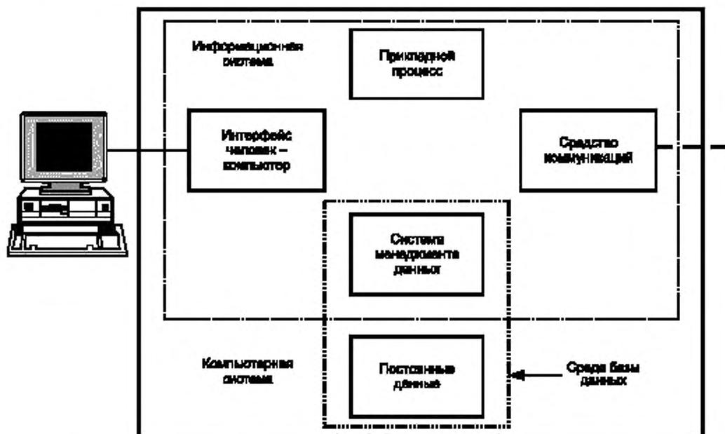
Рисунок 1 — Положение системы управления данными в информационной системе
