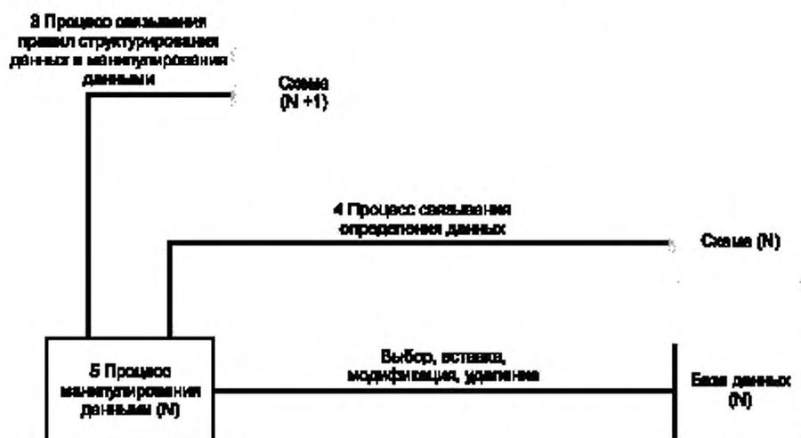
Рисунок 6 — Связывание данных и манипулирование данными
