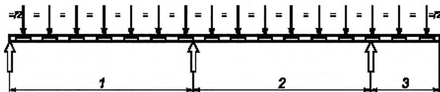
1 — концевой пролет длиной  $L$  или  $X$ , указанной изготовителем, 2 — промежуточный пролет длиной  $L$ ,
