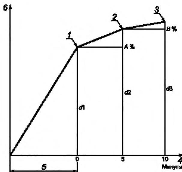
1 — показания приборов  $d_1$ , 2 — показания приборов  $d_2$ , 3 — показания приборов  $d_3$ ; 4 — время; 5 — время нагружения до БРН. 6 — определение приращения прогиба по формулам
