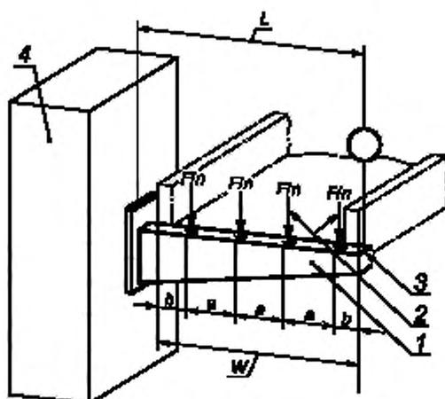
1 — консольный кронштейн, 2 — прикладываемая нагрузка, 3 — точка измерения прогиба, расположенная на средней линии консольного кронштейна, 4 — основание,  $L$  — полная длина кронштейна;  $W$  — внешняя ширина кабельного лотка,  $F/n$  — сила;  $n$  — места приложения нагрузки в соответствии с приложением D;  $a$  — расстояние, равное  $W/n$ ;  $b$  — расстояние, равное  $a/2$
