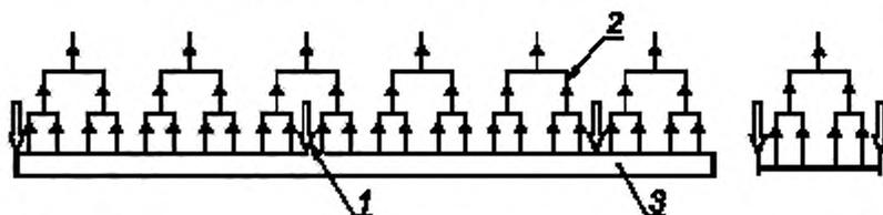
1 — опора. 2 — механическая передача от гидравлического цилиндра или другого устройства, которая должна обеспечивать создание равных точечных нагрузок на плитах (плите) распределения нагрузки; 3 — образец, расположенный вверх дном
