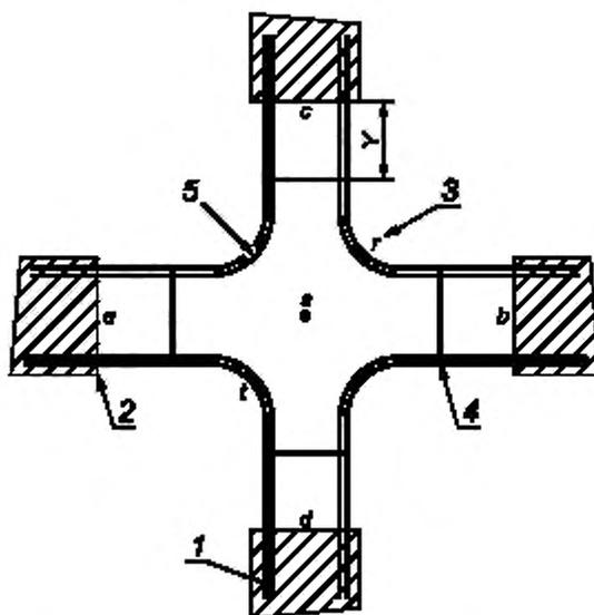
1 — закрепленный участок трассы; 2 — край опоры *a*, *b*, *c* или *d*; 3 — точки *a*, *b* и *t* измерения прогибов; 4 — типичное положение стыков; 5 — радиус секции; *Y* — расстояние от опоры до места соединения секций, указанное изготовителем
