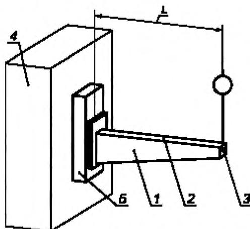
1 — консольный кронштейн для установки на кабельной стойке; 2 — поверхность, к которой прикладывают нагрузку; 3 — точка измерения прогиба, расположенная на средней линии на конце консольного кронштейна; 4 — основание; 5 — кабельная стойка для установки кронштейна, закрепленная на жестком основании (стойка не используется, если кронштейн предназначен для закрепления непосредственно на основании); L — длина кронштейна
