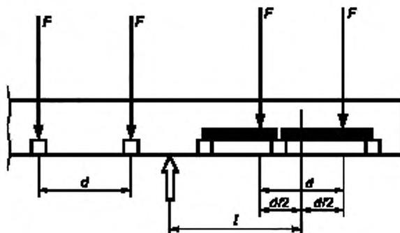
$$M_{\text{с.с.}} = M_{\text{рн}} = (F + F) l, \text{ следовательно, } l = \frac{M_{\text{рн}}}{2F},$$
