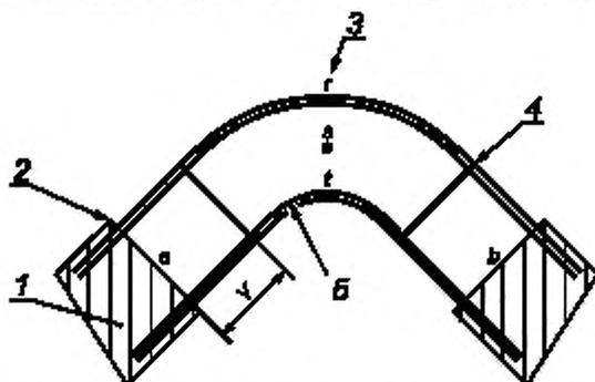
1 — закрепленный участок трассы; 2 — край опоры  $a$  или  $b$ ; 3 — точки  $a, s$  и  $t$  измерения прогибов; 4 — типичное положение стыков; 5 — радиус секции;  $Y$  — расстояние между опорой и местом соединения секций, указанное изготовителем
