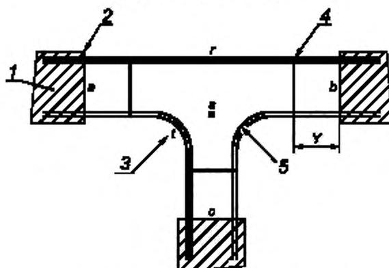
1 — закрепленный участок трассы; 2 — край опоры  $a, b$  или  $c$ ; 3 — точки  $a, s$  и  $t$  измерения прогибов; 4 — типичное положение стыков; 5 — радиус секции;  $Y$  — расстояние между опорой и местом соединения секций, указанное изготовителем
