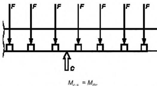
где  $F$  — нагрузка на перемычку в промежуточном и концевом пролете;  $C$  — опора;  $M_{c.c.}$  — значение фактического крутящего момента относительно опоры  $C$ ;  $M_{гр.}$  — значение расчетного момента относительно опоры  $C$
