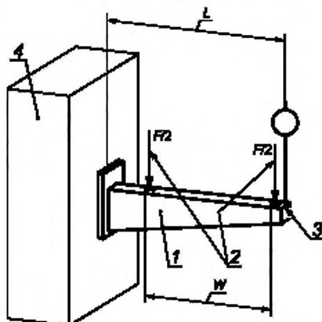
1 — консольный кронштейн, 2 — места приложения силы  $F$ ; 3 — точка измерения прогиба, расположенная на средней линии на конце консольного кронштейна; 4 — жесткое основание; L — длина кронштейна; W — расстояние между средними линиями опорных поверхностей бортов кабельной лестницы
