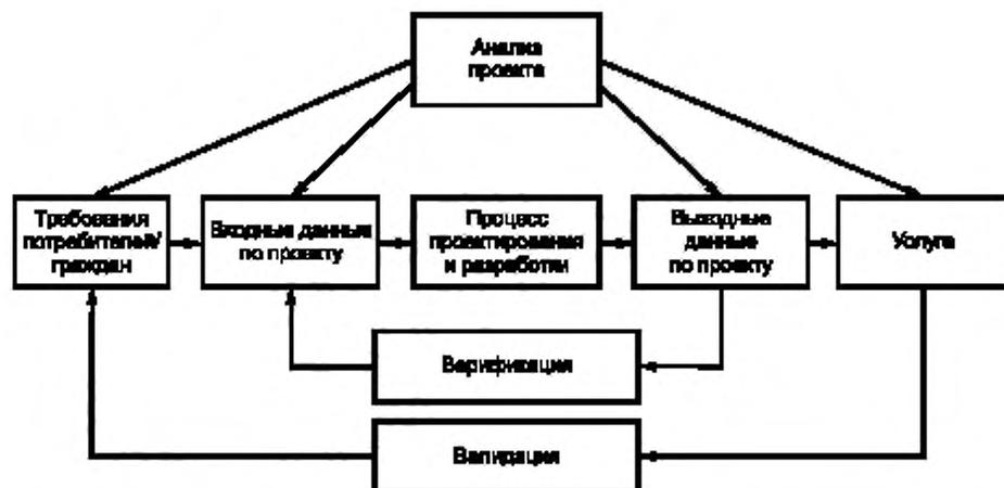
Рисунок 3 — Процесс проектирования и разработки
