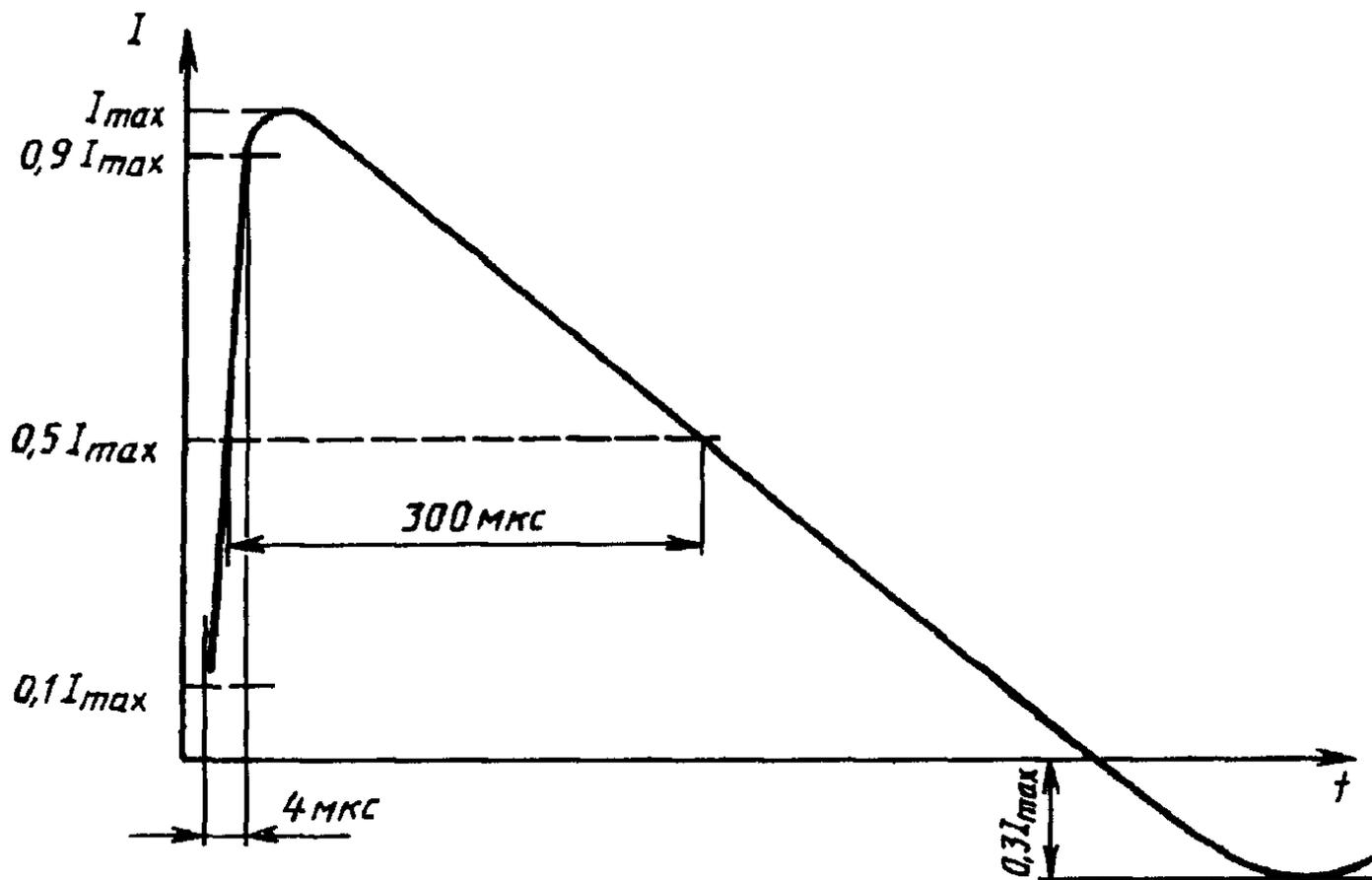
Рисунок 5 — Форма импульса тока на короткозамкнутом выходе ИГ
