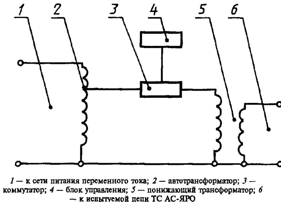
Рисунок 1 — Упрощенная схема ИГ кратковременных синусоидальных токов помех
