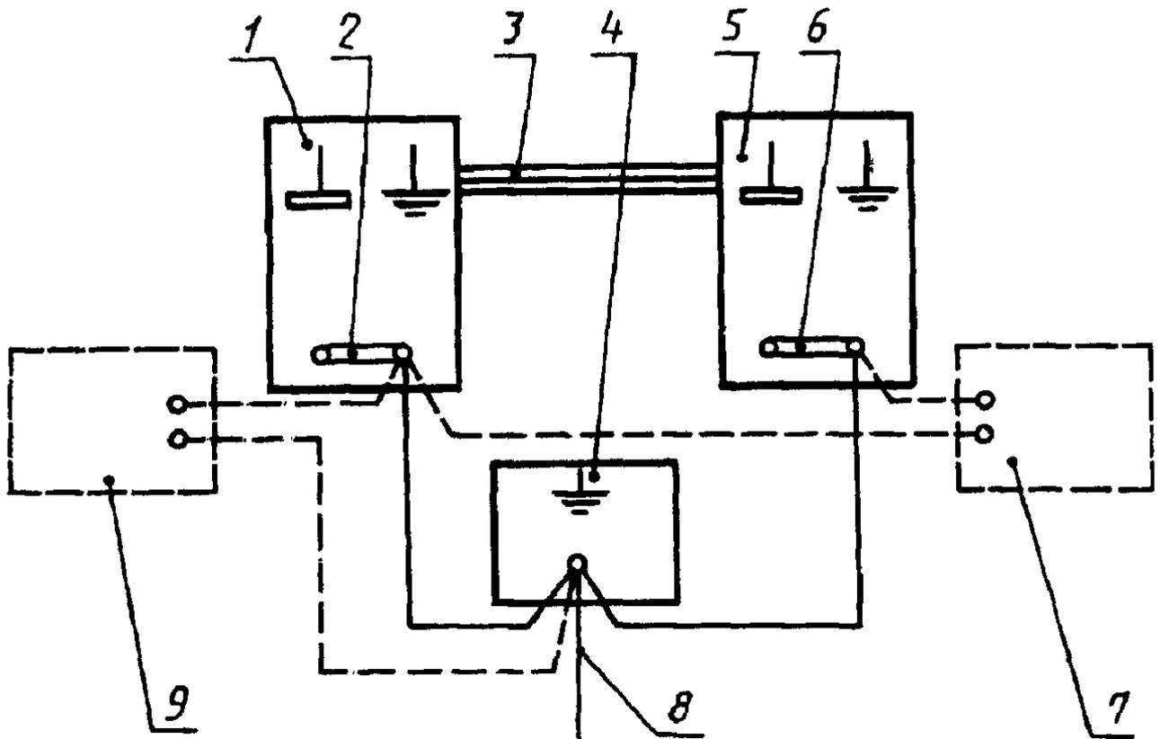
1 — первая стойка испытуемого ТС АС-ЯРО; 2, 6 — переключки между сигнальной и защитной системами заземления в стойке; 3 — линии связи между стойками; 4 — опорный узел заземления ТС АС-ЯРО; 5 — *n*-я стойка испытуемого ТС АС-ЯРО; 7 — подключение ИГ к зажимам защитного заземления двух стоек; 8 — цепь связи с физической землей; 9 — подключение ИГ к зажиму защитного заземления стойки и к опорному узлу заземления
