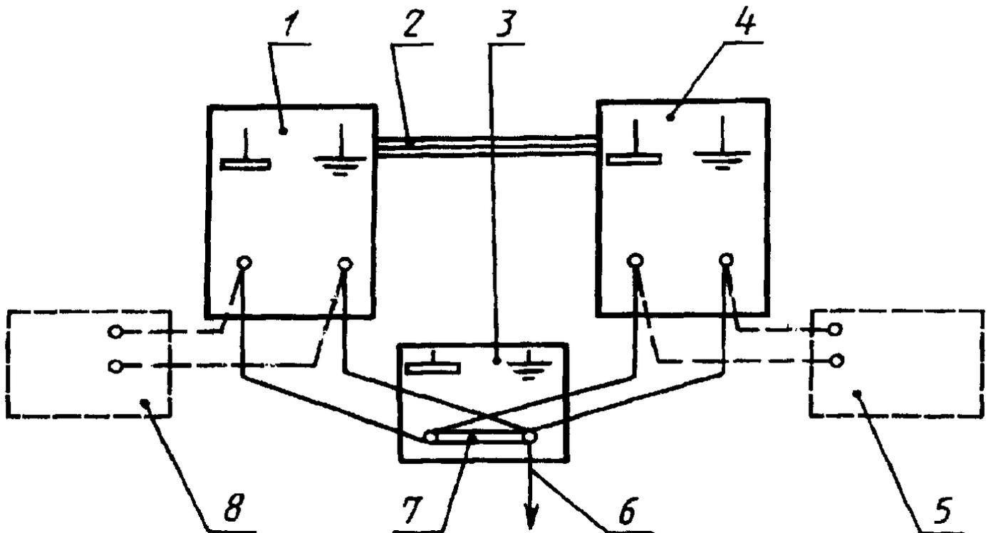
1 — первая стойка испытуемого ТС АС-ЯРО; 2 — линии связи между стойками; 3 — опорный узел заземления ТС АС-ЯРО; 4 —  $n$ -я стойка испытуемого ТС АС-ЯРО; 5 — подключение ИГ к  $n$ -й стойке испытуемого ТС АС-ЯРО; 6 — цепь связи с физической землей; 7 — переключки между сигнальной и защитной системами заземления; 8 — подключение ИГ к первой стойке испытуемого ТС АС-ЯРО
