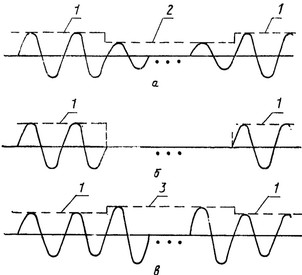
*а* — провал напряжения; *б* — прерывание напряжения; *в* — выброс напряжения;
