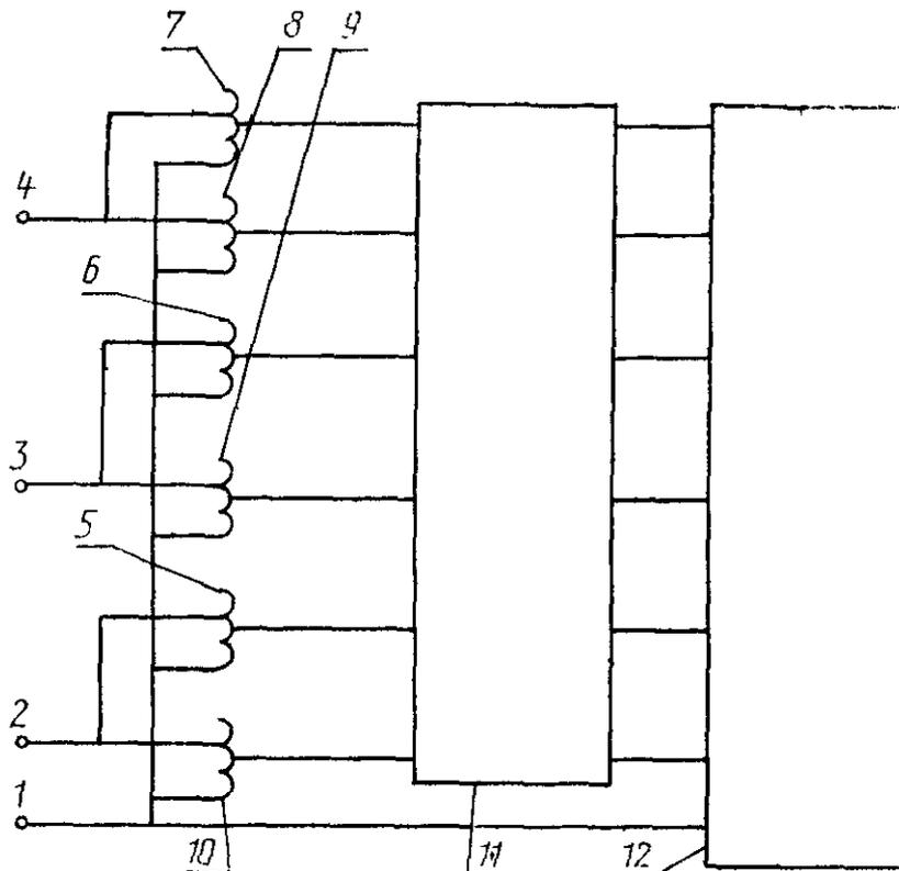
1 — нейтральный провод сети электропитания; 2, 3, 4 — фазные провода сети электропитания; 5, 6, 7 — источники номинального напряжения; 8, 9, 10 — источники повышенного (пониженного) напряжения; 11 — ИГ; 12 — ИТС
