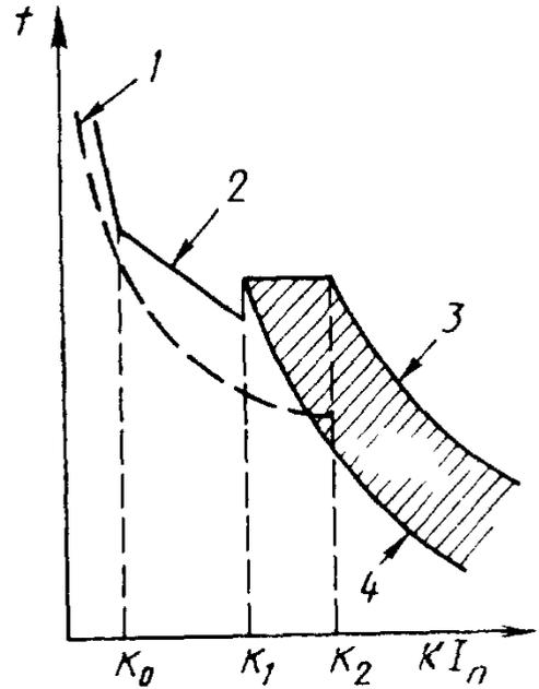
1 – времятоковая характеристика отключения подсоединенного коммутационного аппарата для защиты от сверхтоков; 2 – перегрузочная характеристика; 3 – характеристика отключения; 4 – преддуговая характеристика
