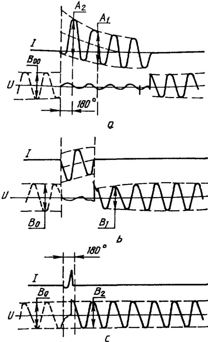
*a* – калибровка цепи; *b, c* – осциллограммы отключения в случае, когда образование дуги начинается соответственно после и до  $180^\circ$  с момента включения
