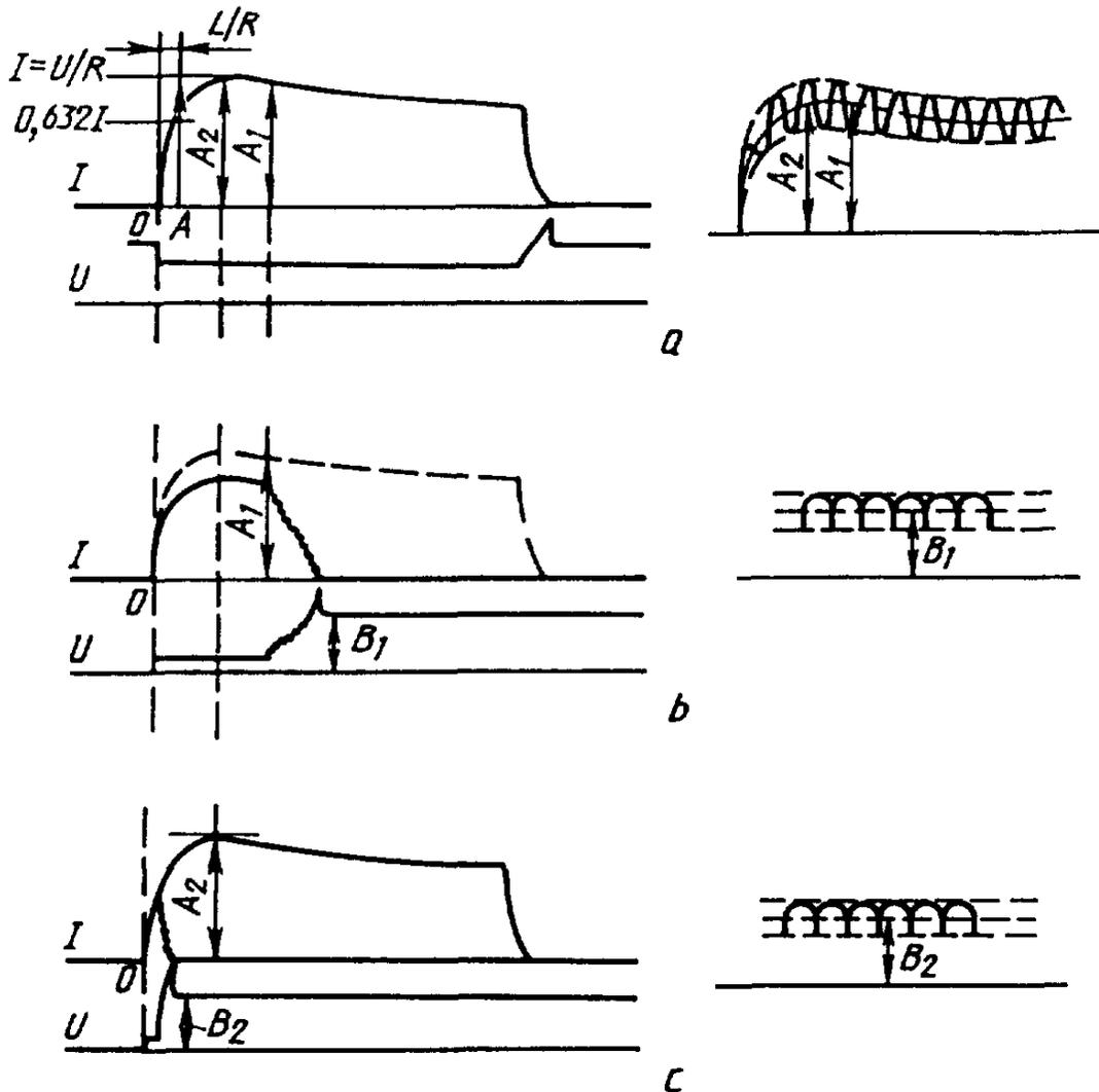
*a* – калибровка цепи. При наличии вибрации следует измерять значения, соответствующие  $0,632 I$ ;  $A_1$  и  $A_2$  – на кривой действующих значений;
