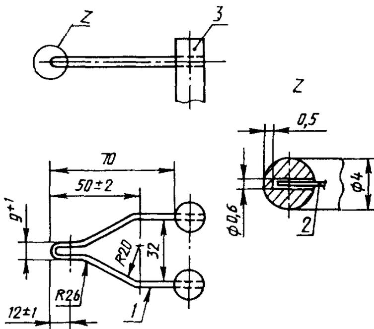
1 – раскаленная проволока с твердым припоем в точке 3; 2 – термопара; 3 – штифт
