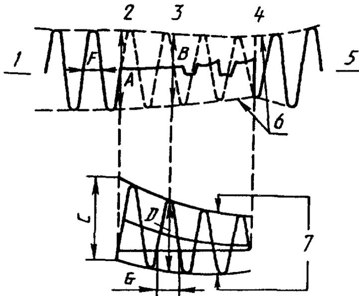
1 — напряжение до включения; 2 — короткое замыкание; 3 — начало образования дуги; 4 — окончательное гашение дуги; 5 — восстанавливающееся напряжение; 6 — огибающая волны электродвижущей силы в цепи; 7 — огибающая волны тока короткого замыкания
