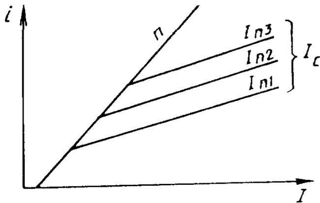
$I_{n1}$ ,  $I_{n2}$ ,  $I_{n3}$  — номинальные токи плавких вставок;  $I_c$  — максимальное значение пропускаемого тока;  $n$  — коэффициент, зависящий от значения коэффициента мощности (асимметричное короткое замыкание)
