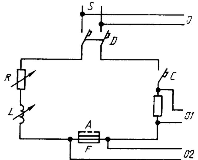
$A$  — съемное соединение, применяемое при калибровке;  $C$  — аппарат, замыкающий цепь;  $D$  — автоматический выключатель или другой аппарат для защиты источника питания;  $F$  — испытуемый плавкий предохранитель;  $L$  — регулируемая катушка индуктивности;  $O1$  — измерительная цепь для записи тока;  $O2$  — измерительная цепь для записи напряжений во время испытаний;  $O$  — измерительная цепь для записи напряжения во время калибровки;  $R$  — регулируемый резистор;  $S$  — источник питания
