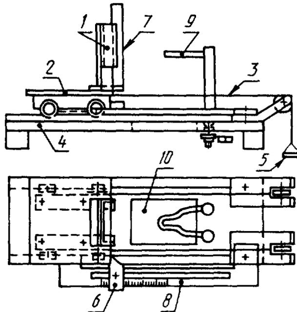
1 – опора для образца; 2 – тележка; 3 – натяжной канат; 4 – фундаментная плита; 5 – груз; 6 – регулируемый упор; 7 – линейка для измерения пламени; 8 – линейка для измерения проникновения; 9 – раскаленная проволока (см. рис. 7); 10 – отверстие в фундаментной плите для частиц, падающих с образца
