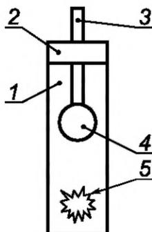
1 — реакционная пробирка; 2 — пробка; 3 — стеклянная палочка; 4 — реагент на стеклянном шарике;
