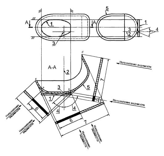
1- освещающая поверхность, 2- исходная ось, 3- исходный центр; 4- угол геометрической видимости; 5- светоизлучающая поверхность, 6- видимая освещающая поверхность; 7- видимая светоизлучающая поверхность
