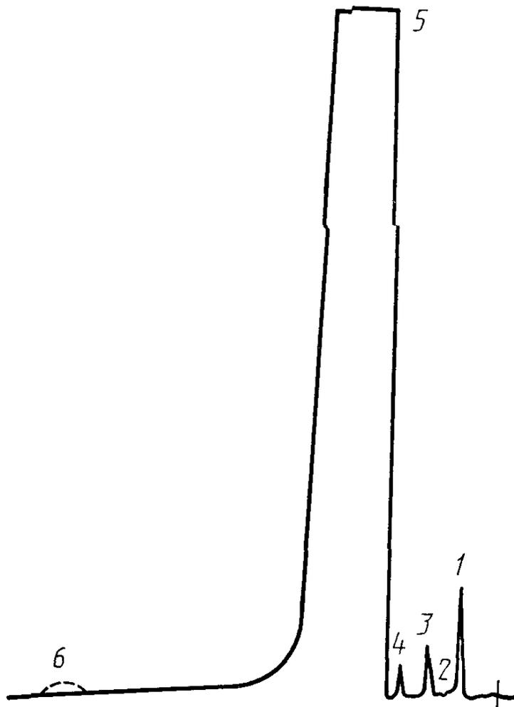
1—воздух; 2—диоксид углерода; 3—трифторметан, 4—дифтордихлорметан, 5—дифторхлорметан; 6—фтордихлорметан
