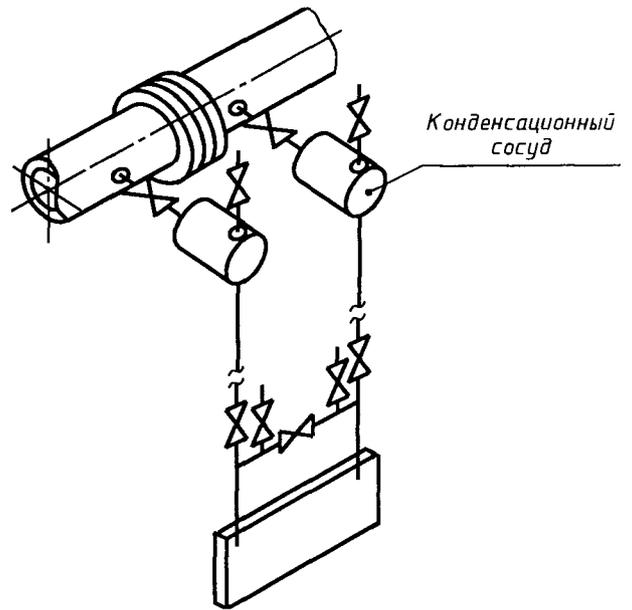
Рисунок В.5 — Дифманометр под трубопроводом
