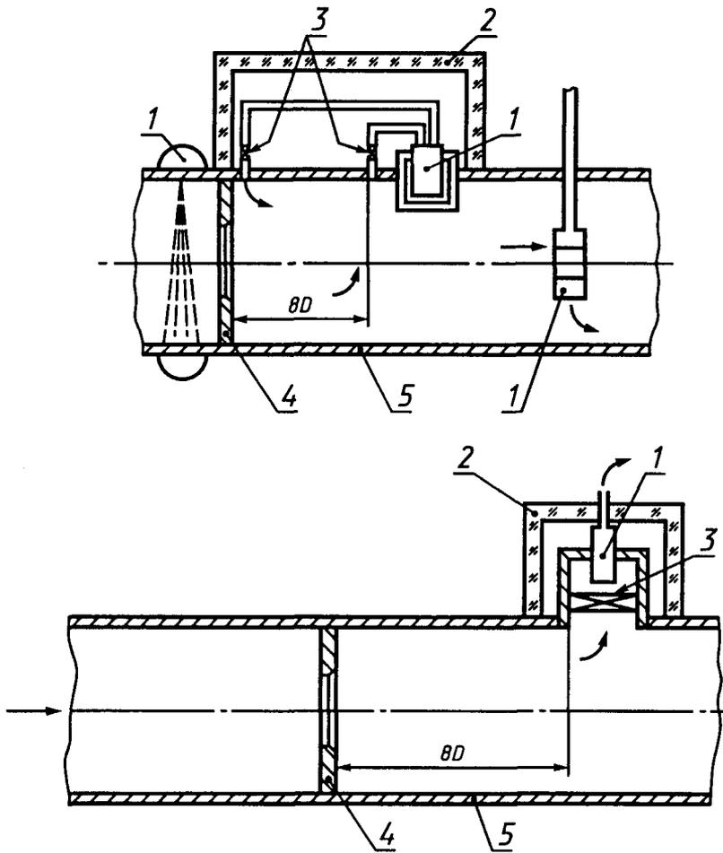
1 — плотномер; 2 — теплоизоляция; 3 — вентиль; 4 — сужающее устройство; 5 — трубопровод
