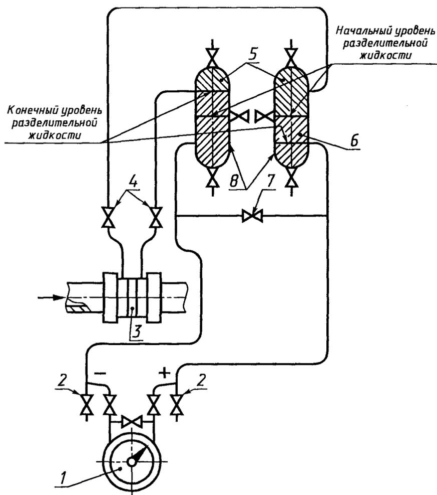
1 — дифференциальный манометр; 2 — продувочный вентиль; 3 — сужающее устройство; 4 — запорный вентиль сужающего устройства; 5 — контролируемый газ; 6 — разделительная жидкость; 7 — уравнивающий вентиль; 8 — разделительный сосуд
