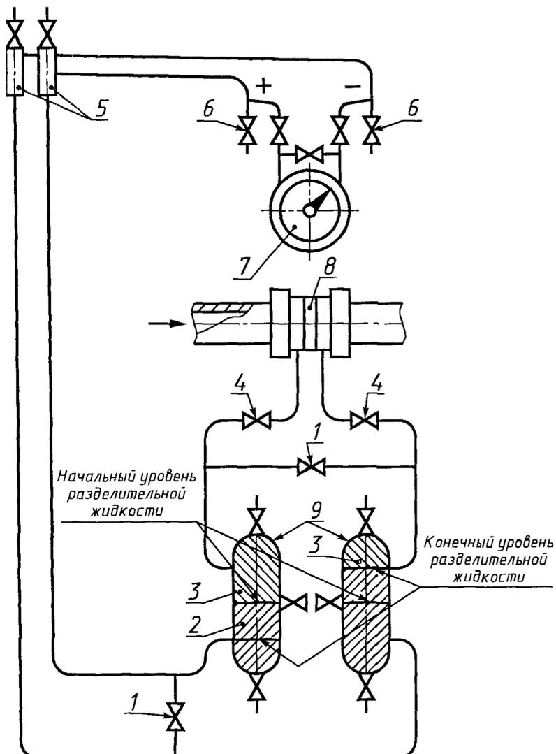
1 — уравнивающий вентиль; 2 — разделительная жидкость; 3 — контролируемая жидкость; 4 — запорный вентиль; 5 — газосборник; 6 — продувочный вентиль; 7 — дифференциальный манометр; 8 — сужающее устройство; 9 — разделительный сосуд
