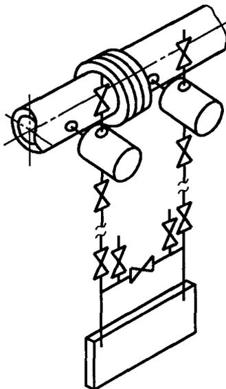
Рисунок В.6 — Дифманометр под трубопроводом (вариант)
