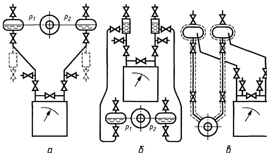
Рисунок 3 — Схемы расположения уравнильных сосудов и соединительных трубок. Дифманометр находится: а — ниже сужающего устройства; б — выше сужающего устройства (при  $p > 2 \text{ кг/см}^2$ ); в — выше сужающего устройства (при  $p \leq 2 \text{ кг/см}^2$ )
