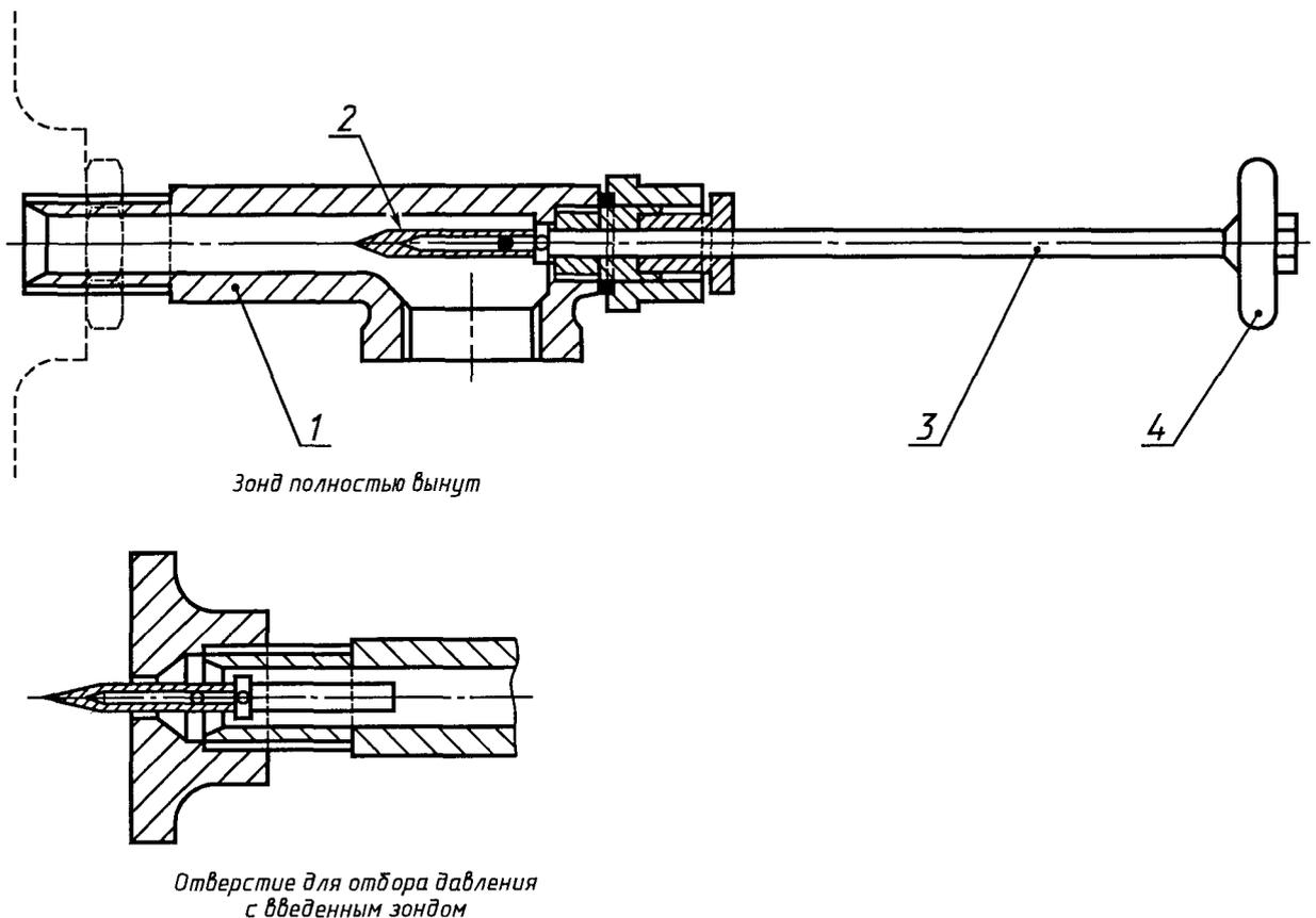
1 — корпус; 2 — головка зонда; 3 — ось зонда; 4 — рукоятка
