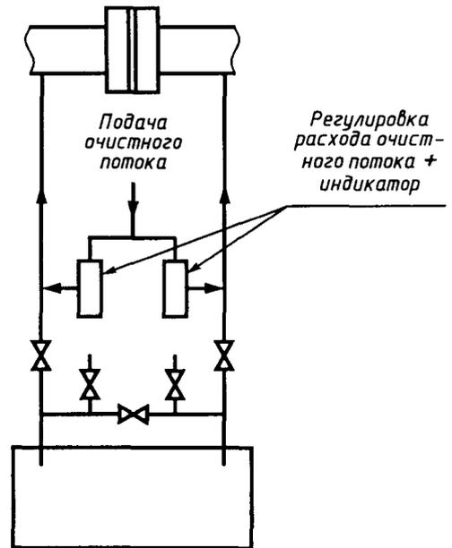
Рисунок 9 — Пример установки очистной системы
