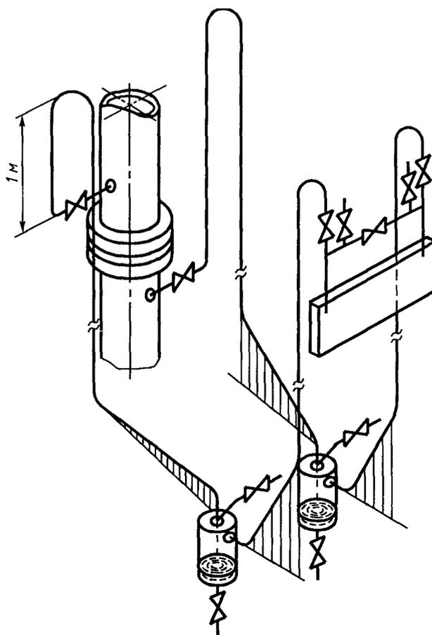
Рисунок В.12 — Дифманометр ниже отверстий
