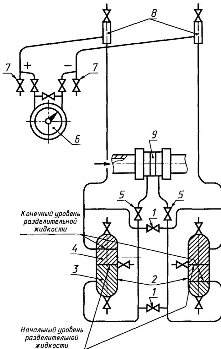
1 — уравнивающий вентиль; 2 — разделительный сосуд; 3 — контролируемая жидкость; 4 — разделительная жидкость; 5 — запорный вентиль сужающего устройства; 6 — дифференциальный манометр; 7 — продувочный вентиль; 8 — газосборник; 9 — сужающее устройство
