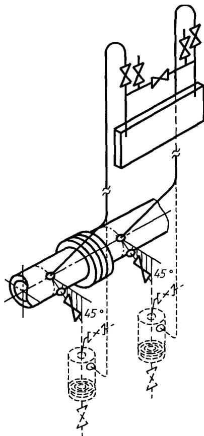
Рисунок В.11 — Дифманометр над трубопроводом
