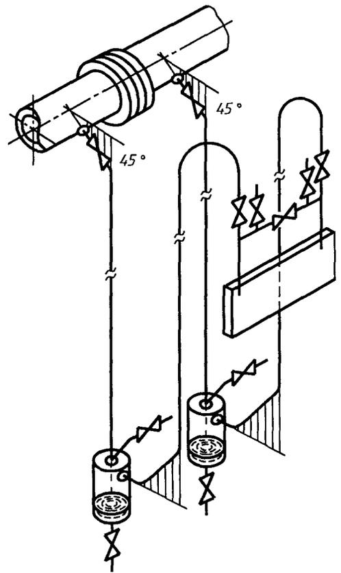
Рисунок В.10 — Дифманометр под трубопроводом (вариант)
