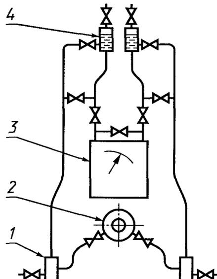
1 — отстойная камера; 2 — сужающее устройство; 3 — дифманометр; 4 — воздухо-сборник
