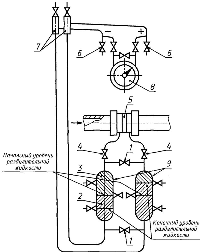
1 — уравнивательный вентиль; 2 — разделительная жидкость; 3 — контролируемая жидкость; 4 — запорный вентиль сужающего устройства; 5 — сужающее устройство; 6 — продувочный вентиль; 7 — газосборник; 8 — дифференциальный манометр; 9 — разделительный сосуд
