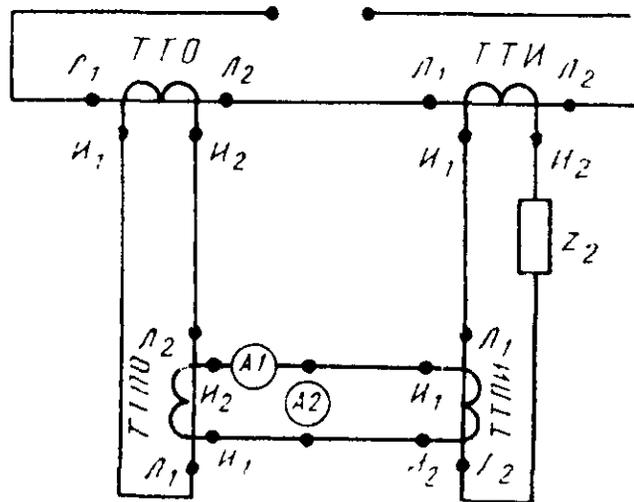
*ТТО*—трансформатор тока образцовый; *ТТИ*—трансформатор тока испытуемый; *ТПИ*—трансформатор тока промежуточный, находящийся в цепи испытуемого трансформатора тока; *ТПО*—трансформатор тока промежуточный, находящийся в цепи образцового трансформатора тока; *A1*, *A2*—амперметры; *Z<sub>2</sub>*—вторичная нагрузка в цепи испытуемого трансформатора тока.
