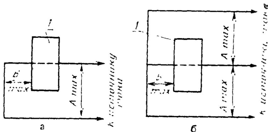
$I$ —испытуемый трансформатор;  $A$ —расстояние между осями проводников соседних фаз в месте установки трансформатора в эксплуатации;  $B$ —расстояние в свету от трансформатора до места ближайшего изгиба проводника, служащего в эксплуатации первичной обмоткой трансформатора.
