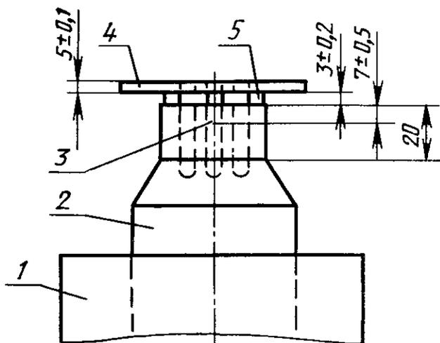
1 — нагревательный элемент; 2 — металлическая часть; 3 — термопара; 4 — изоляционная плита; 5 — прокладка; 6 — контур вилки
