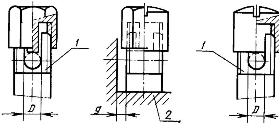
1 — фиксатор; 2 — деталь соединителя с отверстием для контактного зажима;  $D$  — место расположения проводника (нижняя часть места расположения проводника должна быть слегка закруглена для обеспечения надежного соединения с проводником)
