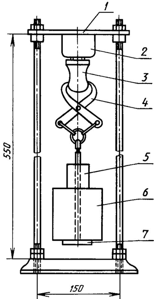
1 — держатель; 2 — образец; 3 — испытательная вилка; 4 — захват; 5 — дополнительный груз; 6 — основной груз; 7 — опора
