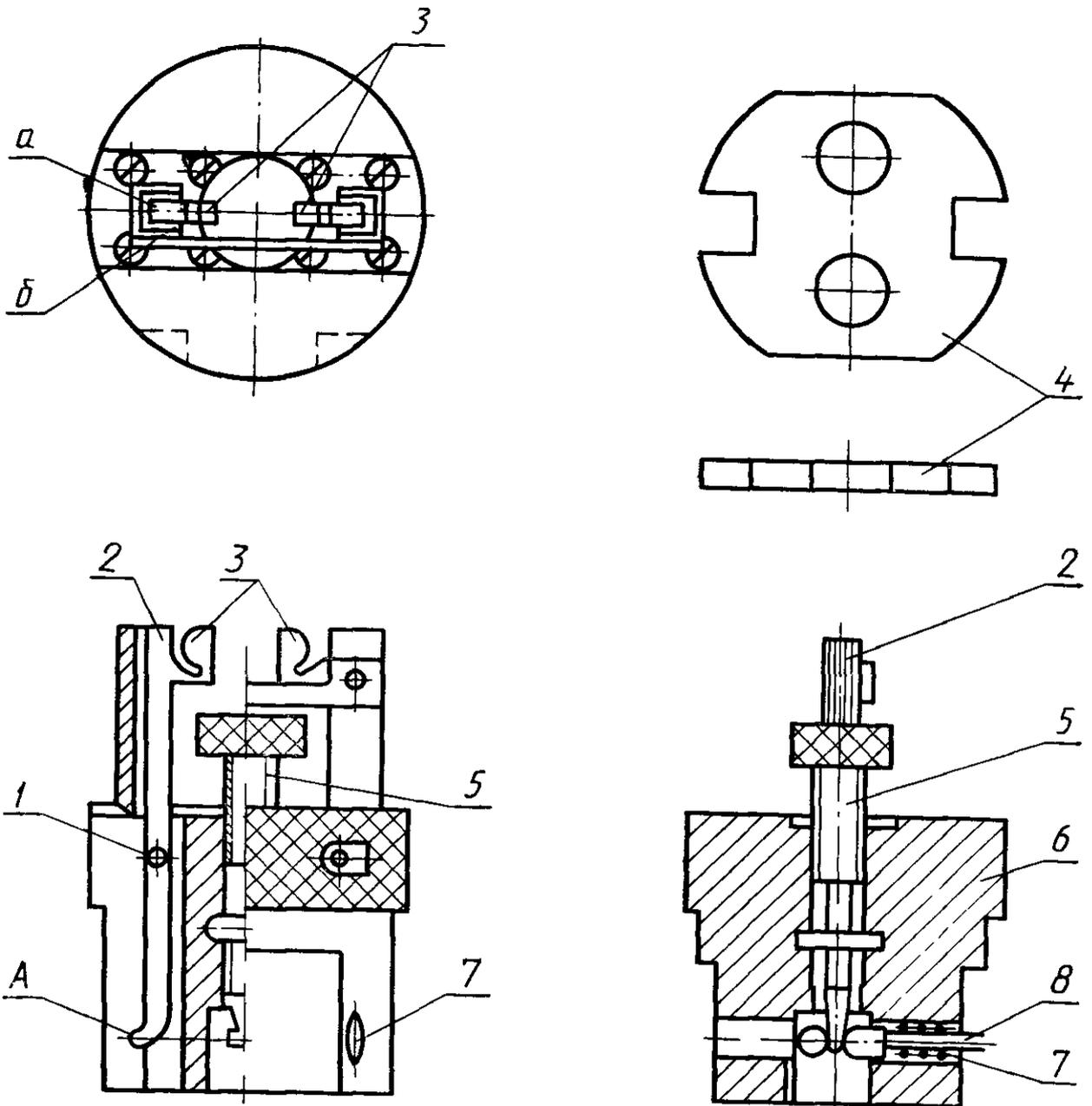
1 — ось рычага; 2 — поворотный рычаг; 3 — крючки; 4 — калиброванные кулачки;
