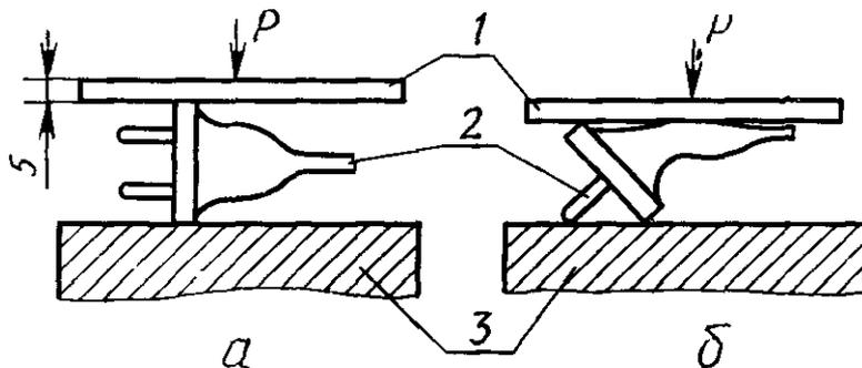
$P$  — усилие в 150 Н; 1 — стальная нажимная пластина; 2 — образец; 3 — стальное основание
