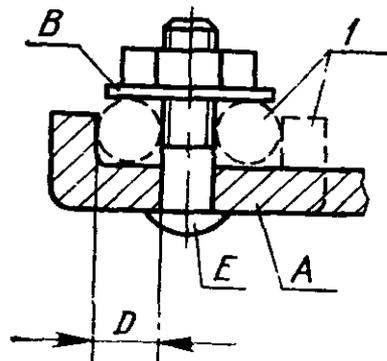
*A* — деталь неподвижная; *B* — прокладка или прижимная пластина; *C* — деталь специальная прижимная; *D* — место расположения проводника; *E* — винт; *1* — возможный вариант
