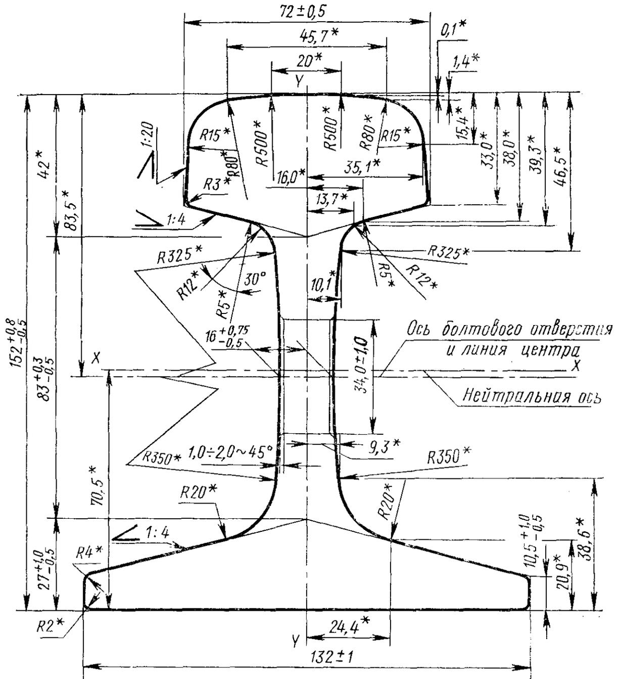
\* Размеры обеспечиваются инструментом.
