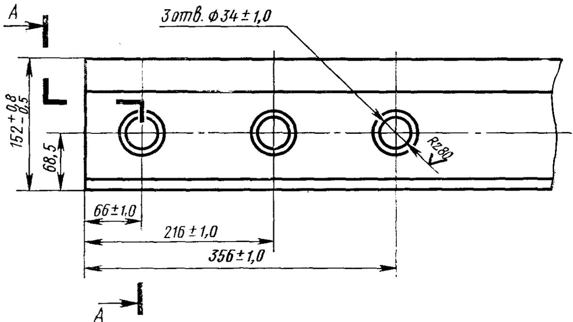
Примечание. Расположение болтовых отверстий контролируется по клиновидной части пазухи.
