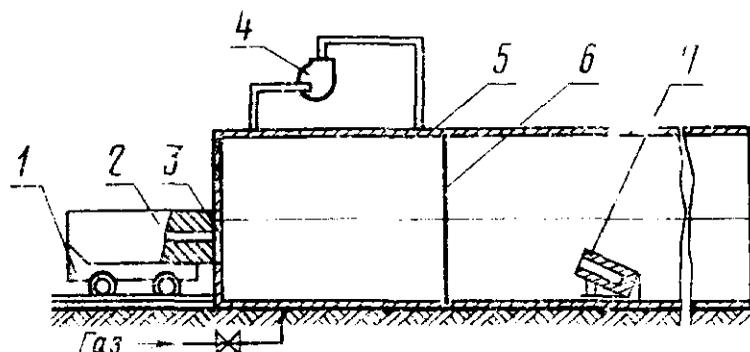
1—тележка; 2—канальная mortира; 3—люк штрека; 4—вентилятор; 5—труба штрека; 6—диафрагма; 7—распылительная mortира
