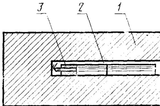
1—стальной цилиндр; 2—несквозной канал; 3—заряд ВВ с электродетонатором
