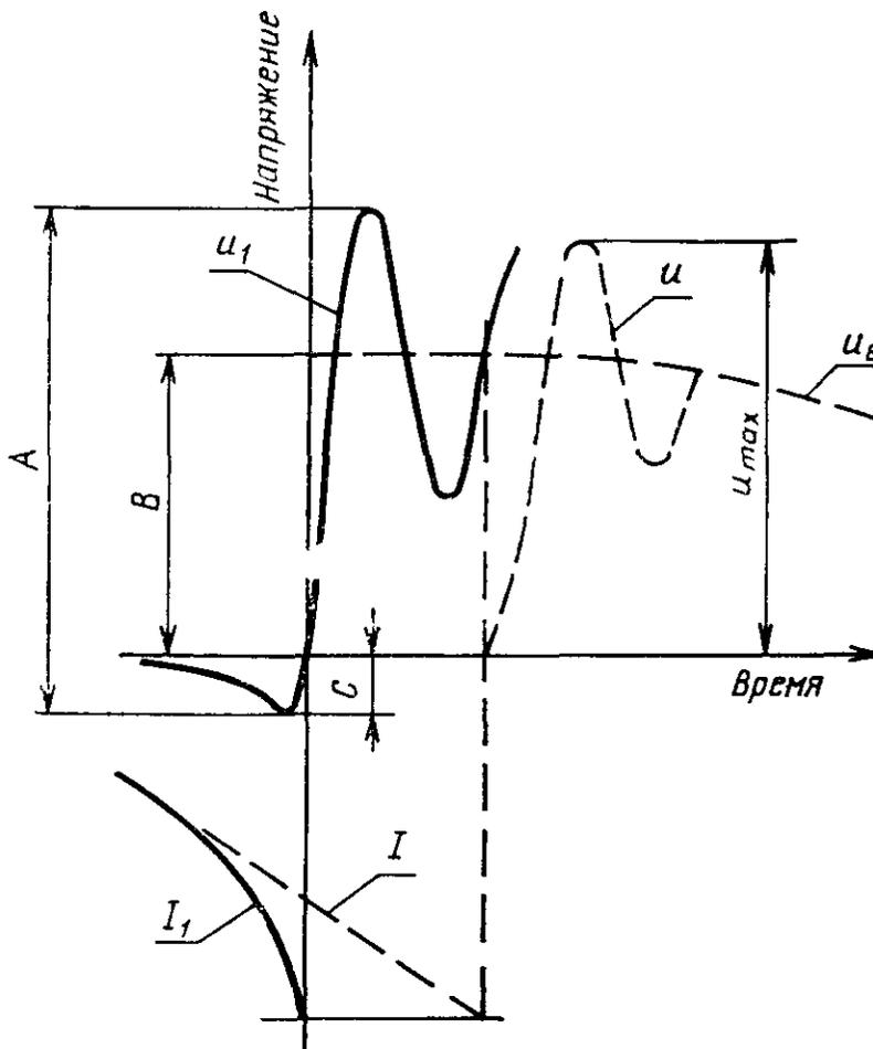
$u_1, I_1$  — напряжение и ток в опыте;  $u, I$  — собственное ПВН и ожидаемый ток;  $u_{\max}$  — возвращающееся напряжение
