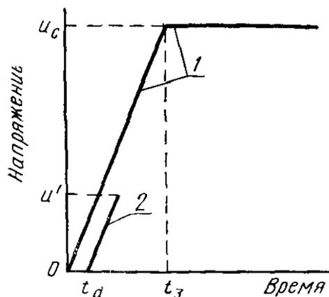
1—условная граничная линия ПВН, 2—линия запаздывания ПВН (параллельная граничной линии)
