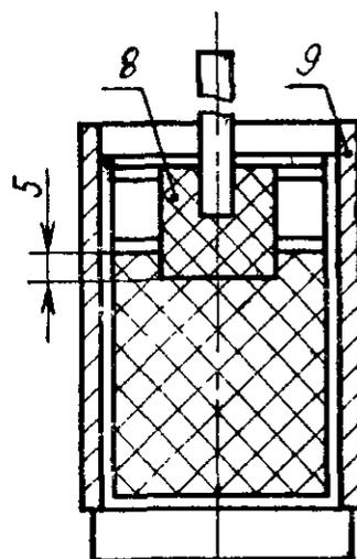
1—электродетонатор или капсуль—детонатор; 2—картонный кружок; 3—бумажная гильза; 4—испытываемый заряд; 5—стальной диск; 6—цилиндр; 7—плита; 8—промежуточный детонатор; 9—кольцо.
