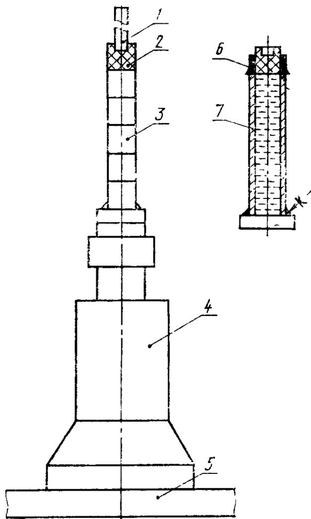
1 — электродетонатор; 2 — промежуточный детонатор; 3 — испытуемый заряд; 4 — бризантометр; 5 — плита; 6 — изоляционная лента; 7 — гильза.
