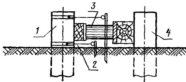
1—испытываемая свая; 2—реперная система с прогибомерами; 3—домкрат с манометром; 4—упор для гидравлического домкрата
