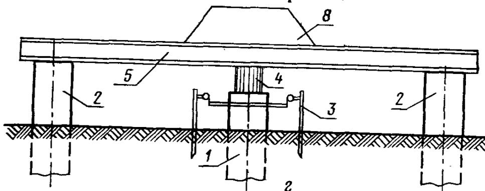
1—испытываемая свая; 2—анкерная свая; 3—реперная система с прогибомерами; 4—домкрат с манометром; 5—система упоров, балок; 6—грузовая платформа; 7—опора; 8—груз (упор для гидравлического домкрата); 9—тарированный груз
