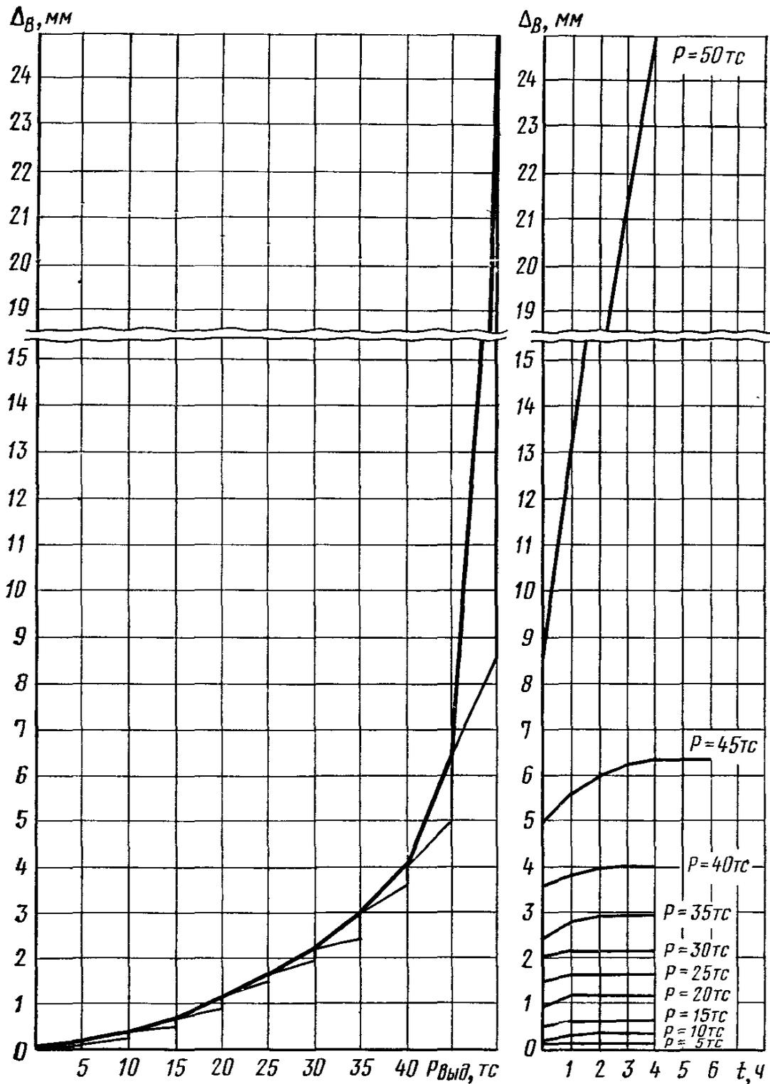
**ОБРАЗЕЦ ГРАФИЧЕСКОГО ОФОРМЛЕНИЯ РЕЗУЛЬТАТОВ ИСПЫТАНИЯ СВАИ
