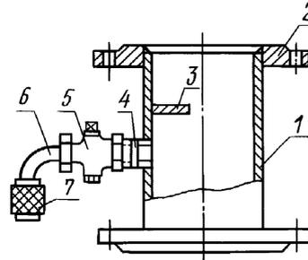
2. Для отбора проб из цистерн используют пробоотборник ВНИИЖ Ш8—МПР (черт. 2), представляющий собой тонкостенную дюралюминиевую трубу 1 внутренним диаметром 40 мм, длиной, равной диаметру цилиндра цистерны и высоте колпака.
