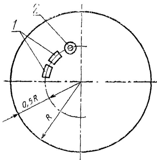
1—два бруска для 4 образцов для испытаний на ударную вязкость, 2—образец для испытания на растяжение
