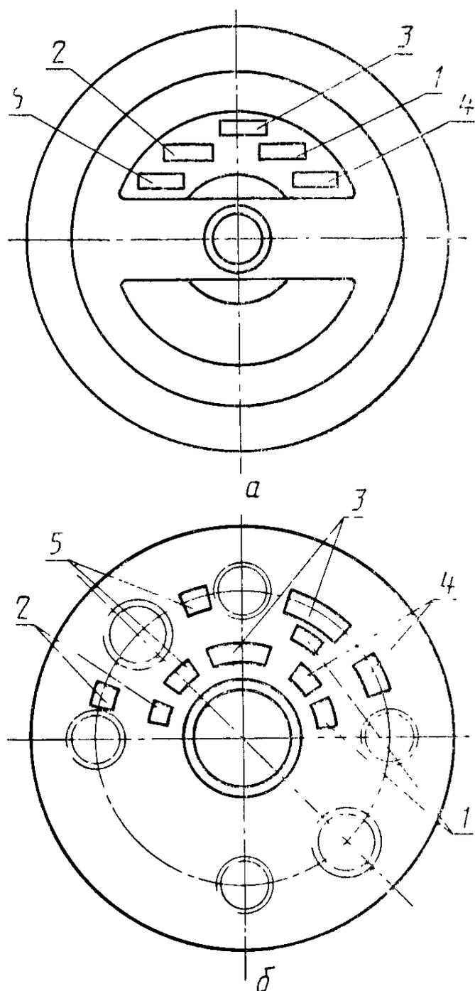
1—клеймо Госприемки; 2—условный номер предприятия, производившего обработку и перенесшего знаки маркировки; 3—номер оси. 4—две последние цифры года изготовления черновой оси; 5—клеймо технического контроля
