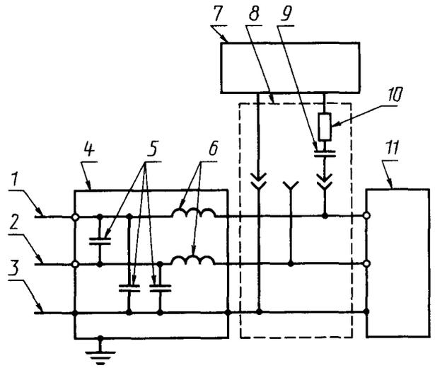
1, 2, 3 — фазный, нейтральный и защитный провода сети электропитания соответственно; 4 — устройство развязки; 5 — конденсаторы развязки; 6 — индуктивности развязки; 7 — ИГ МИП; 8 — устройство связи; 9 — конденсатор связи; 10 — резистор связи; 11 — ИТС
