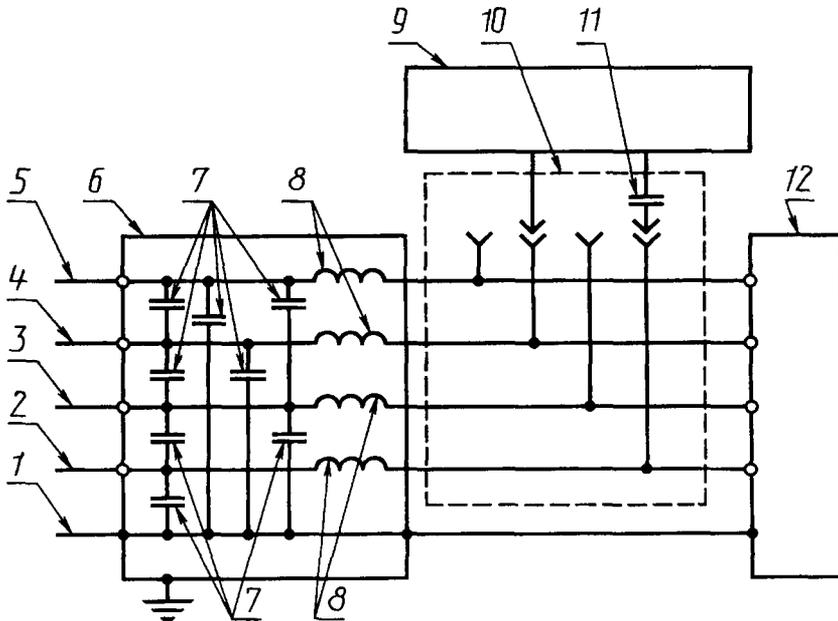
1, 2, 3, 4, 5 — защитный, нейтральный и фазные провода сети электропитания соответственно; 6 — устройство развязки; 7 — конденсаторы развязки; 8 — индуктивности развязки; 9 — ИГ МИП; 10 — устройство связи; 11 — конденсатор связи; 12 — ИТС
