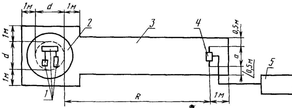
1 — испытуемое устройство; 2 — поворотная платформа; 3 — поверхность площадки, покрытая металлическими листами; 4 — измерительная антенна; 5 — измеритель радиопомех;  $d$  — максимальный размер испытуемого устройства;  $R$  — расстояние от испытуемого устройства до антенны;  $a$  — максимальная длина антенны
