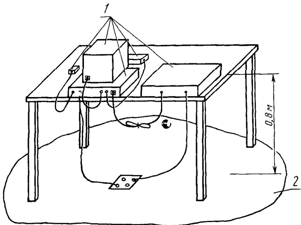
1 — ТС, входящие в состав испытуемого устройства; 2 — поворотная платформа
