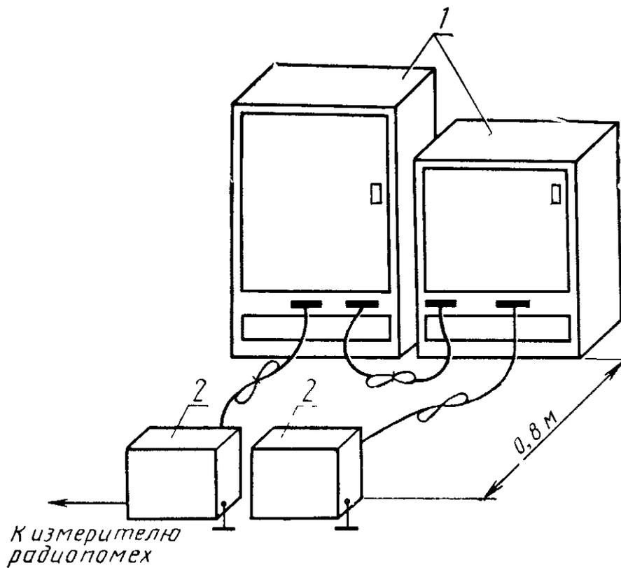
**1 — ТС, входящие в состав испытуемого устройства; 2 — эквивалент сети**
