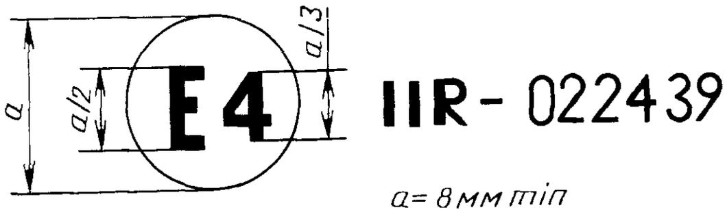
Приведенный знак официального утверждения, проставленный на транспортном средстве, указывает, что на основании Правил № 11 с внесенными в них поправками серии 02 данный тип транспортного средства официально утвержден в Нидерландах (E4) в отношении прочности дверных замков и устройств крепления дверей
