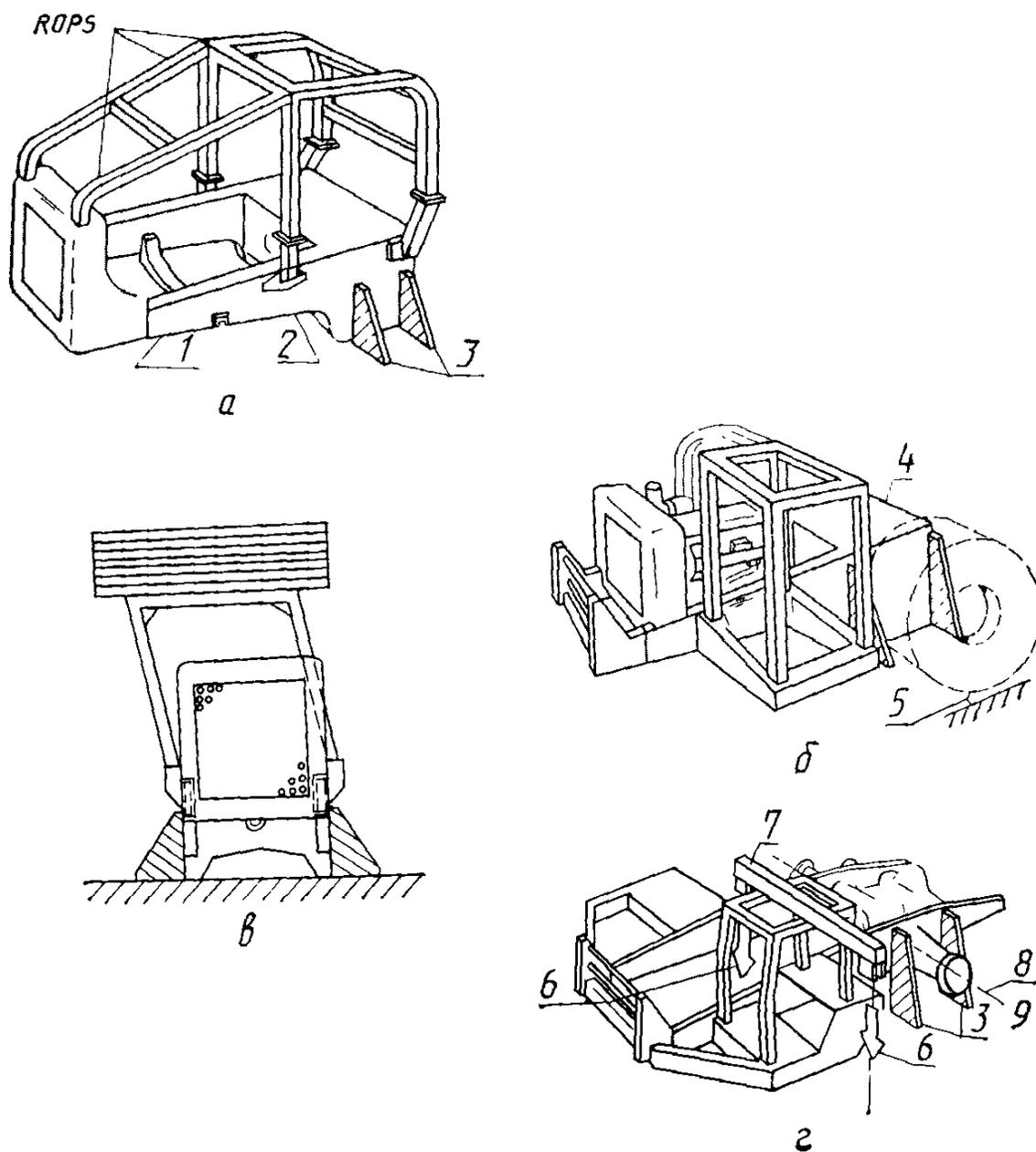
1 — без контакта; 2 — рама машины; 3 — опора; 4 — основной корпус;
