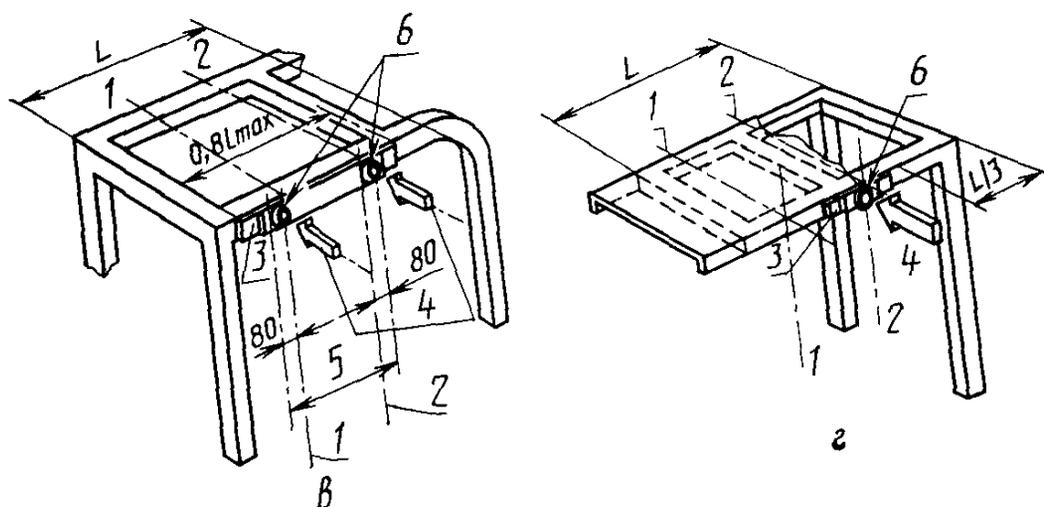
1 — передняя плоскость DLV; 2 — задняя плоскость DLV; 3 — распределитель нагрузки; 4 — усилие; 5 — зона нагружения; 6 — точка приложения нагрузки
