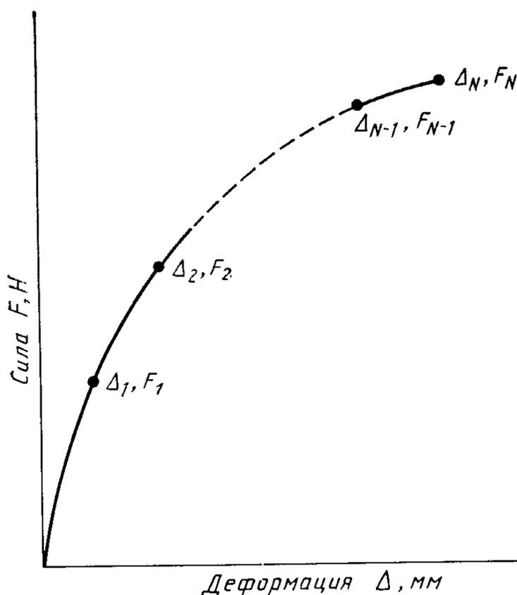
$$\text{Площадь} = \frac{\Delta_1 F_1}{2} + (\Delta_2 - \Delta_1) \left[ \frac{F_1 + F_2}{2} \right] + \dots + (\Delta_N - \Delta_{N-1}) \left[ \frac{F_{N-1} + F_N}{2} \right].$$
