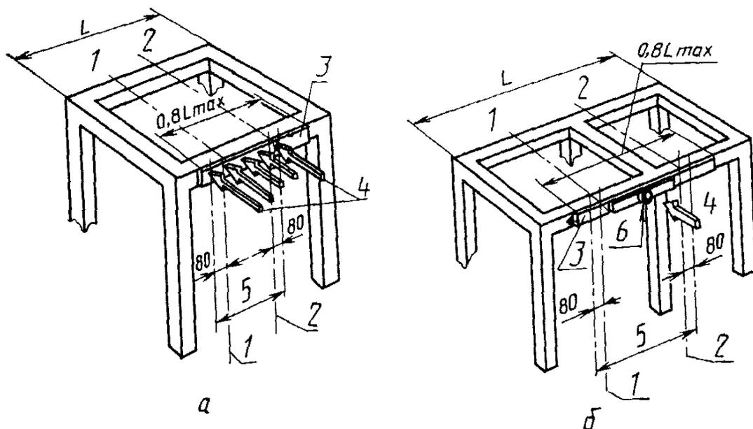
Устройства для распределения нагрузки на четырехстоечной и двухстоечной конструкции
