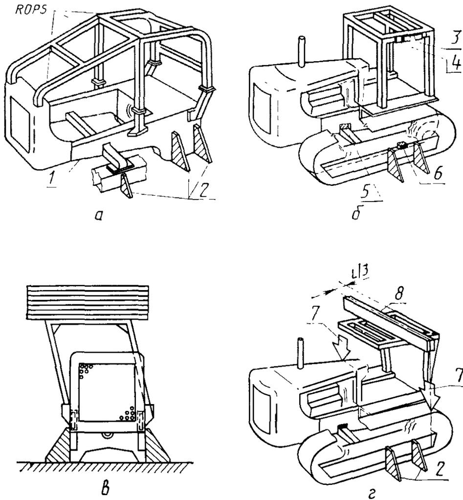
1 — без контакта; 2 — опора; 3 — точка приложения нагрузки; 4 — распределитель нагрузки; 5 — заблокировано для предотвращения информации; 6 — упоры; 7 — усилие; 8 — устройство для приложения вертикальной нагрузки
