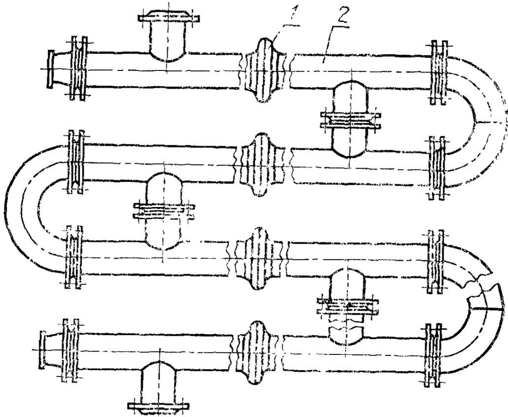
1 — компенсатор теплового расширения; 2 — секции типов РГК, РПК
