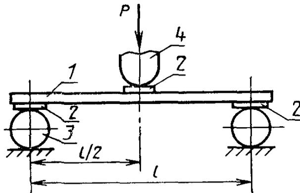
$P$  — нагрузка;  $l$  — расстояние между опорами; 1 — плитка; 2 — резиновая прокладка; 3 — опора; 4 — нажимная кромка
