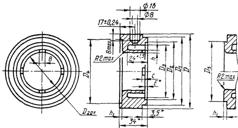
\* Размеры после совместной обработки с диафрагмой не проверяют.
