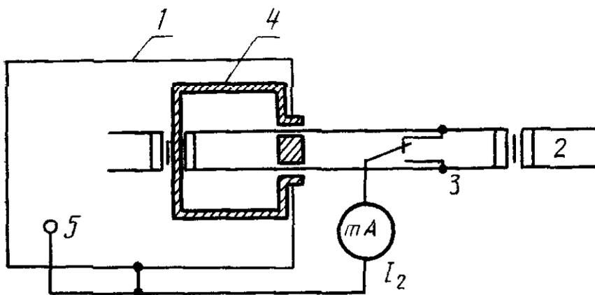
1 — доступные для прикосания токопроводящие части или металлическая фольга, в которую обернут прибор; 2 — сеть электропитания; 3 — переключатель измерений; 4 — дополнительная (защитная) изоляция; 5 — зажимы измерительного заземления
