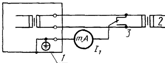
1 — доступные для прикосания токопроводящие части; 2 — сеть электропитания; 3 — переключатель измерений
