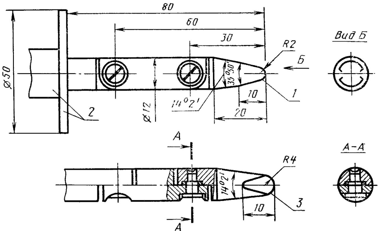
Допуски: на размеры до 25 мм  $\pm 0,05$  мм; свыше 25 мм  $\pm 0,2$  мм; на углы  $\pm 5$
