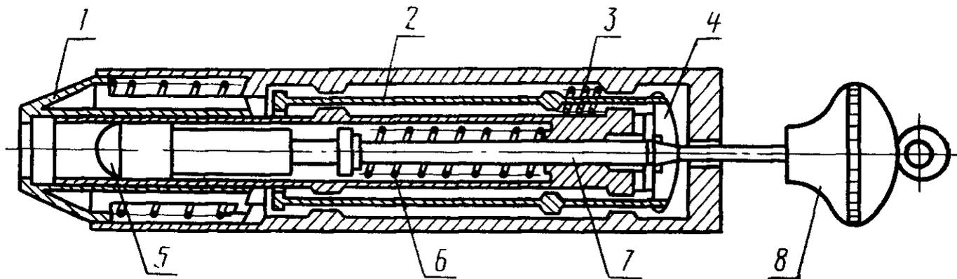
1 — выходной конус; 2 — стержень спускового механизма; 3 — пружина спускового механизма; 4 — спусковой кулачок; 5 — головка молотка; 6 — пружина молотка; 7 — шток;
