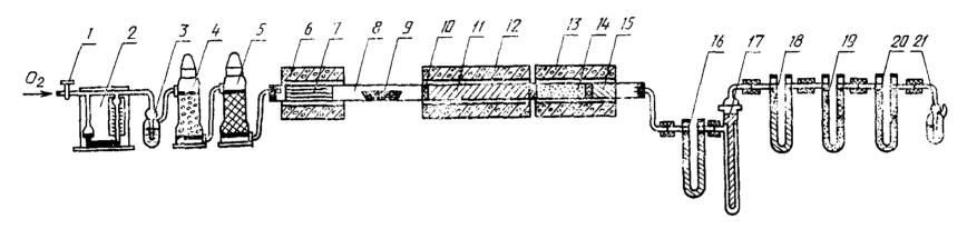
I— кран для регулировки расхода кислорода; 2— расходомер; 3, 4, 5— система очистки вислорода; 6— печь первая; 7— рулон из медной сетки; 8— трубка для сжигания; 9— лодочка с навеской; 10— пробка из медной сетки; 11— оксид меди; 12— печь вторая; 13— печь третья; 14— свинец хромовокислый; 15— рулон из серебряной сетки; 16, 17, 18, 19, 20— поглотительная система; 21— счетчик пузырьков, наполненный концентрированной серной кислотой
