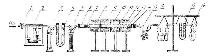
1— кран тонкой регулировки на линии подачи кислорода; 2— реометр для измерения скорости тока кислорода; 3, 4, 5— система очистки кислорода; 6— трубка для сжигания; 7— лодочка с навеской; 8, 9, 10, 12— электропечи типа СУОЛ 0,25.1.1/12МР; 11— гранулированный оксид меди или оксид хрома; 13— плавленый хромовокислый свинец; 14— пробка из медной сетки или из прокаленного волокинстого асбеста; 15, 16, 17— поглотительная система; 18— счетчик пузырьков с концентрированной серной кислотой
