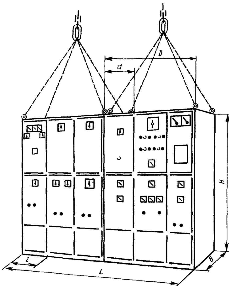
$L$  — длина НКУ;  $d$  — секция;  $l$  — длина секции;  $D$  — транспортная секция;  $B$  — глубина;  $H$  — высота
