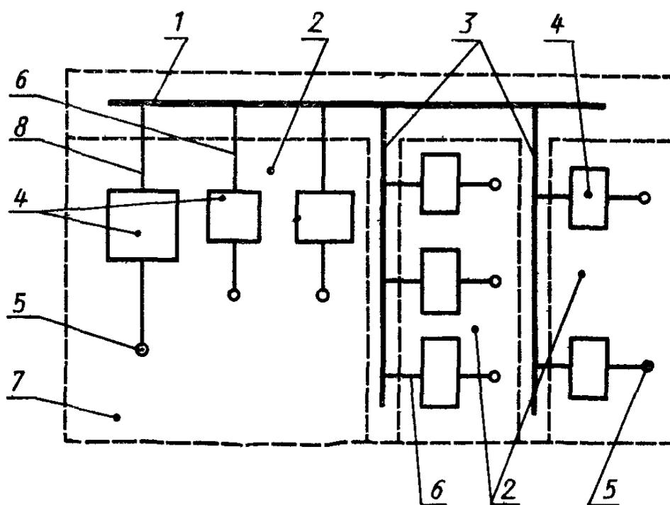
1 — главная шина; 2 — блок вывода; 3 — шина; 4 — устройство защиты от короткого замыкания; 5 — зажим; 6 — проводник, подсоединяющий шину к выходной цепи; 7 — блок ввода; 8 — входная цепь
