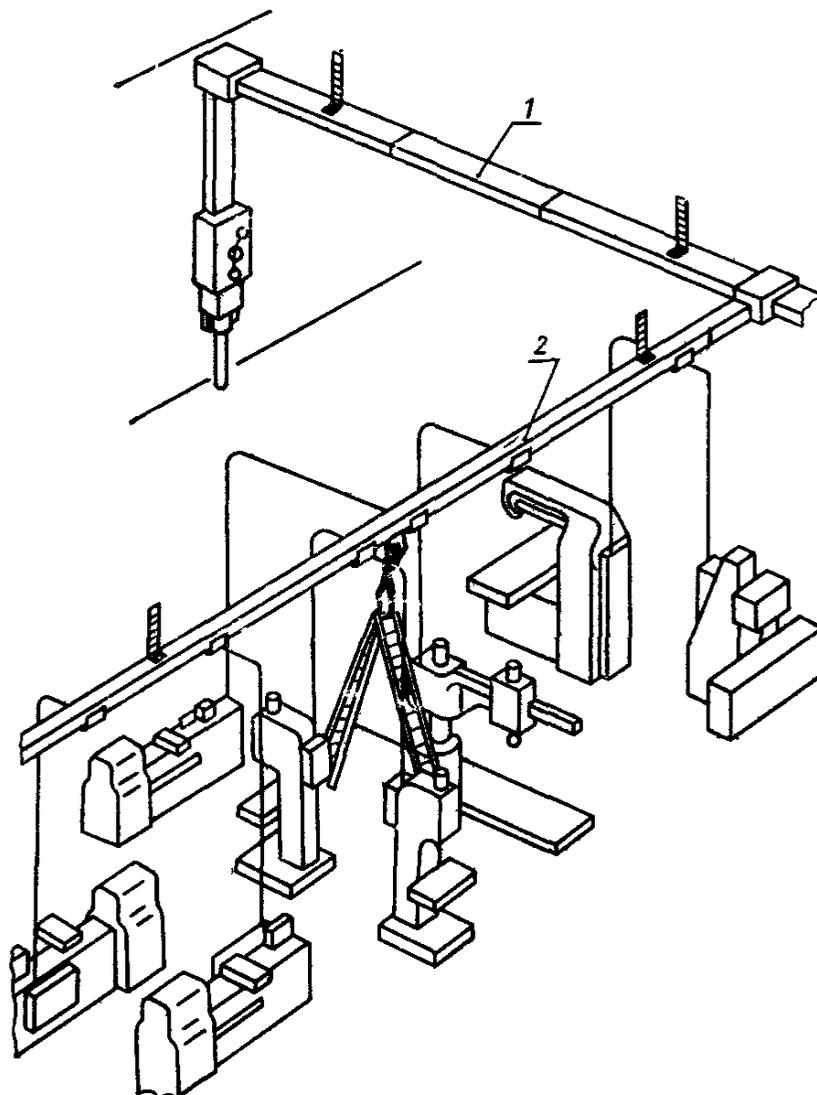
1 — шинопровод без отвода; 2 — шинопровод с отводами
