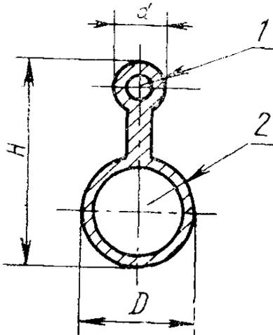
$D$  — диаметр кабеля;  $d$  — диаметр изолированного троса;  $1$  — трос;  $l$  — сердечник;  $H$  — высота кабеля с тросом
