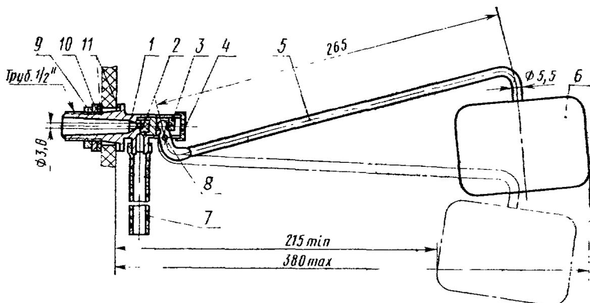
1—корпус; 2—пробка; 3—шток; 4—заглушка; 5—рычаг; 6—поплавок; 7—трубка на-
